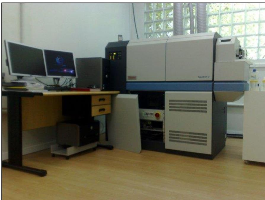
**Figura 13:** Fotografia do ICP-MS Sector Field Thermo Finnigan Element2® utilizado. (LGI/UFRGS, 2021)
