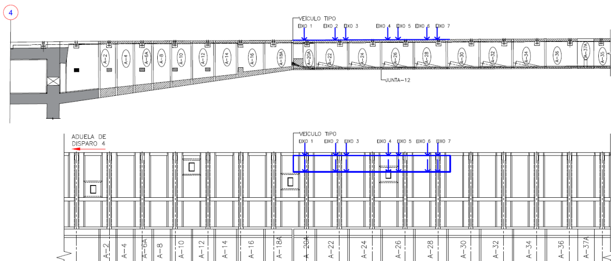
Figura 5.19 – Posicionamento do veículo tipo com o centro de gravidade locado na Junta-12
