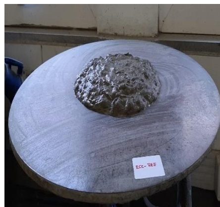
(b) Concreto após o espalhamento
