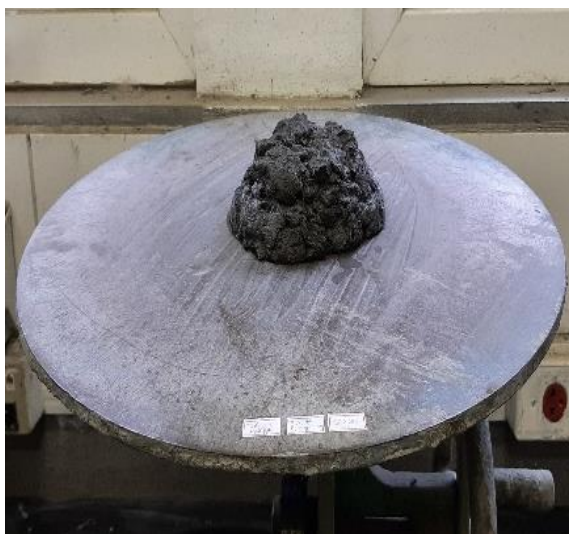
(a) Traço 2.02 (Composição: 0,25% Aditivo superplastificante)
