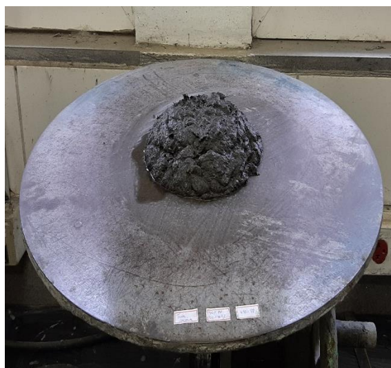
(b) Traço 2.03 (Composição: 0,30% Aditivo superplastificante)
