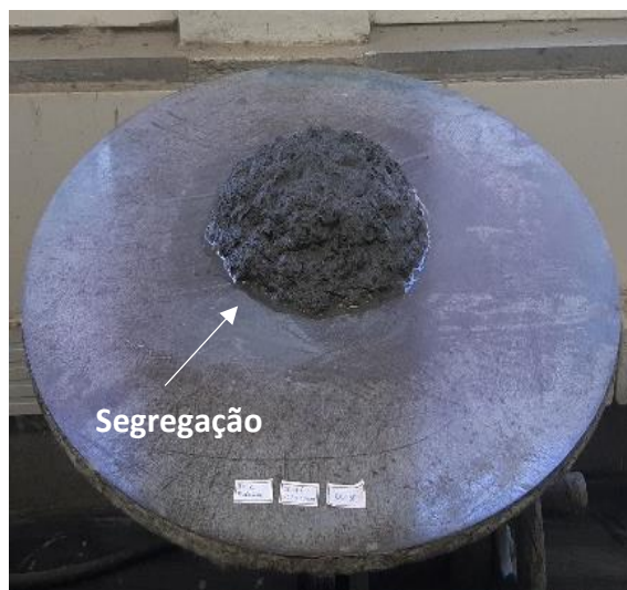
(d) Traço 2.06 (Composição: 0,60% Aditivo superplastificante)
