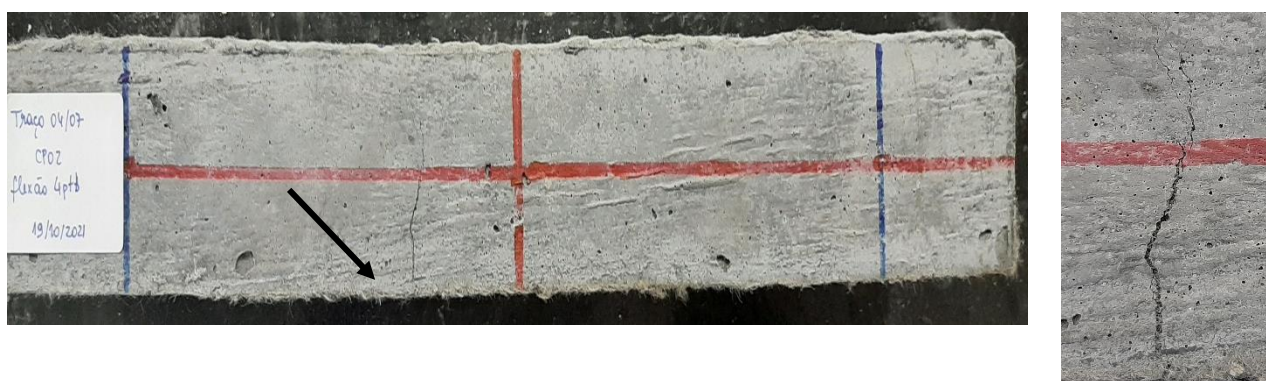
(a) Traço 1.08 – 25% Areia Natural #2,4mm (CP02) - Detalhe da fissura formada
