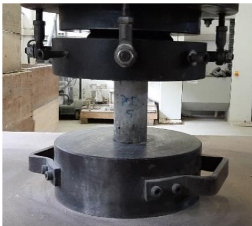
Figura 34 – Ensaio de resistência à compressão
