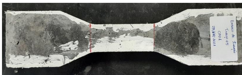
Figura 37 – Corpo de prova preparado para ensaio
