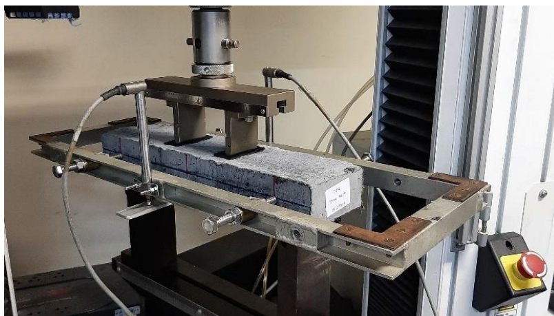
Figura 43 – Ensaio de flexão 4 pontos com LVDT's
