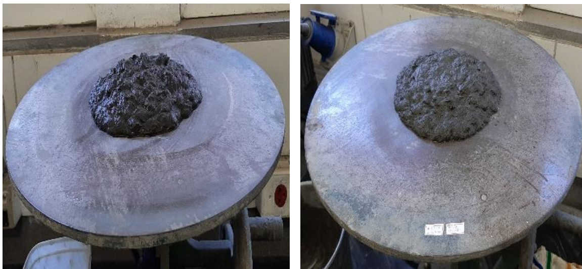
Figura 51 – Avaliação visual do teste de índice de consistência – Areia natural
