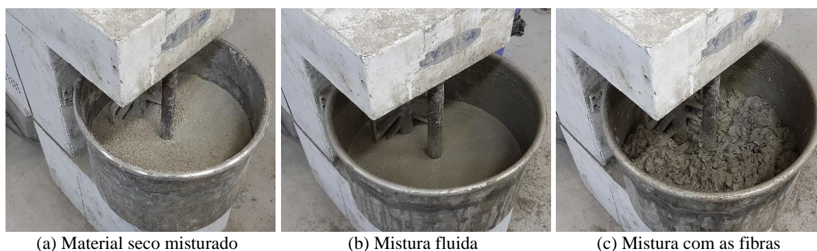
Figura 23 – Processo de mistura do ECC
