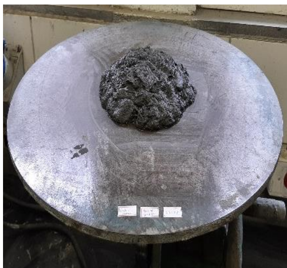
(c) Traço 2.04 (Composição: 0,40% Aditivo superplastificante)
