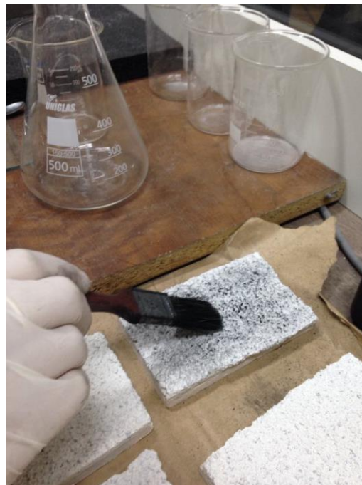
Figura 27 – Aplicação de fuligem sobre placa de argamassa
