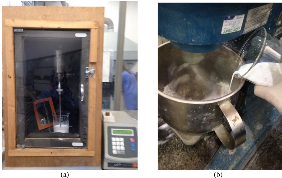
Figura 24 – Adição de \text{TiO}_2 (a) Dispersão de \text{TiO}_2 com equipamento de ultrassom e (b) mistura com argamassa
