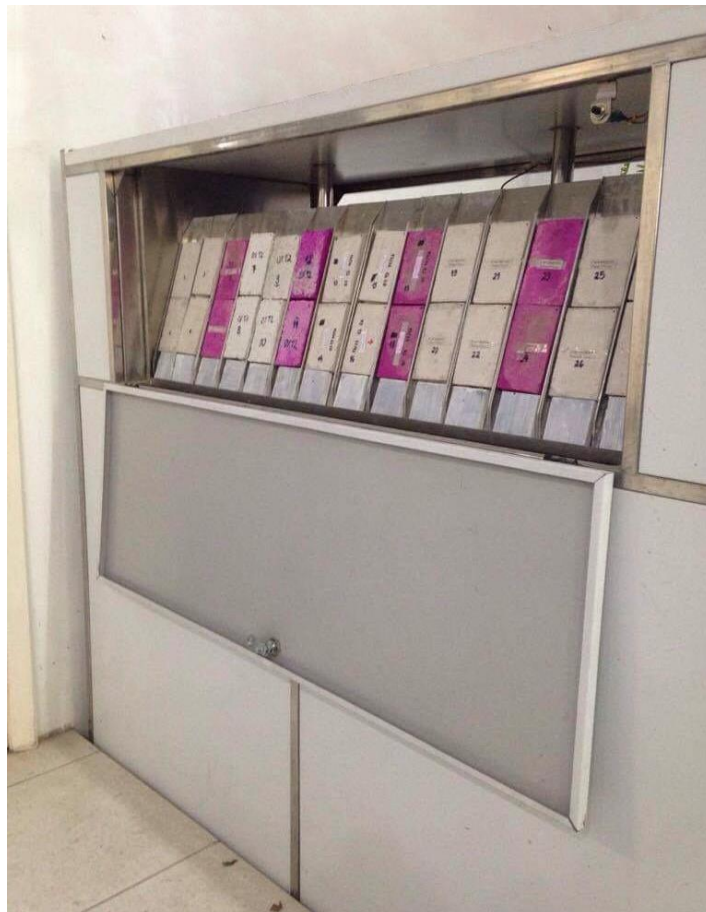
Figura 34 – Câmara 2 de intemperismo com amostras posicionadas antes do acionamento
