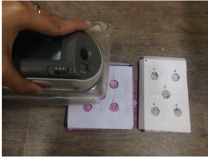
Figura 37 – Medições com espectrofotômetro em placas de argamassa com seus respectivos moldes
