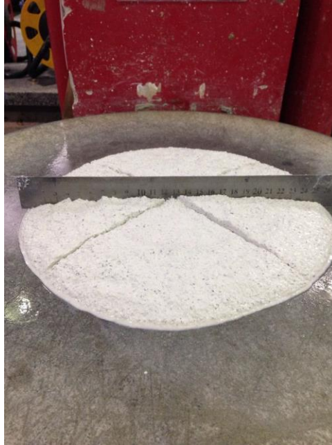
Figura 39 – Aspecto visual da argamassa de revestimento com 5% de adição de \text{TiO}_2 , ao final do ensaio de índice de consistência
