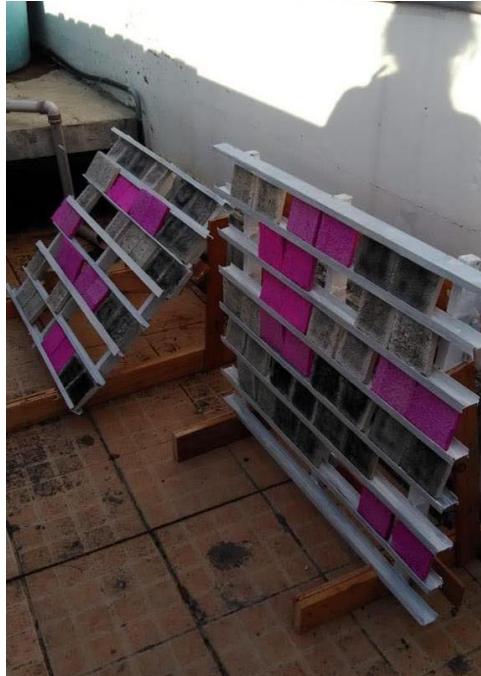
Figura 32 – Exposição das amostras ao ambiente natural, em estruturas metálicas pintadas com tinta impermeabilizante
