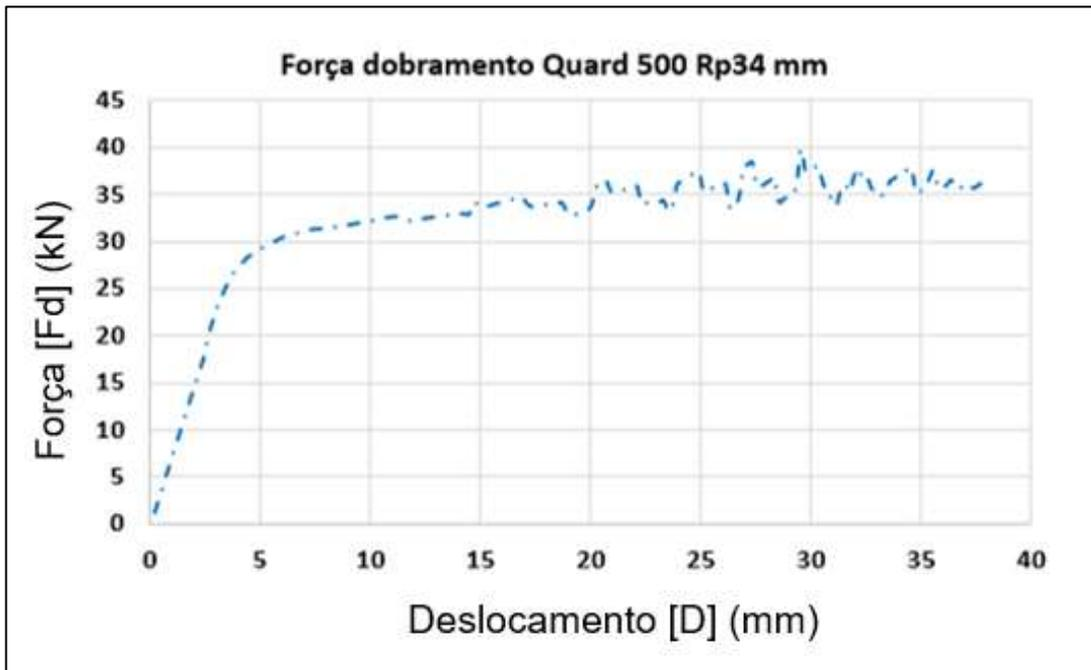
Figura 39 – Curva força x deslocamento Simulada
