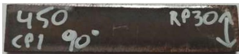
Figura 34 – Identificação dos corpos de prova de dobramento.
