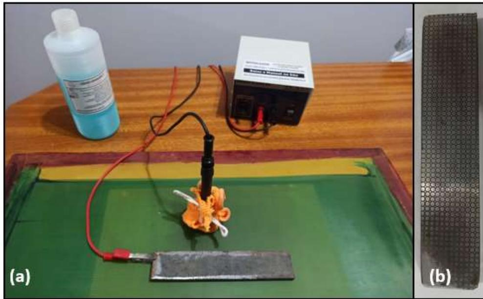
Figura 41 – a) Gravação da grade no corpo de prova; b) Corpo de prova gravado.
