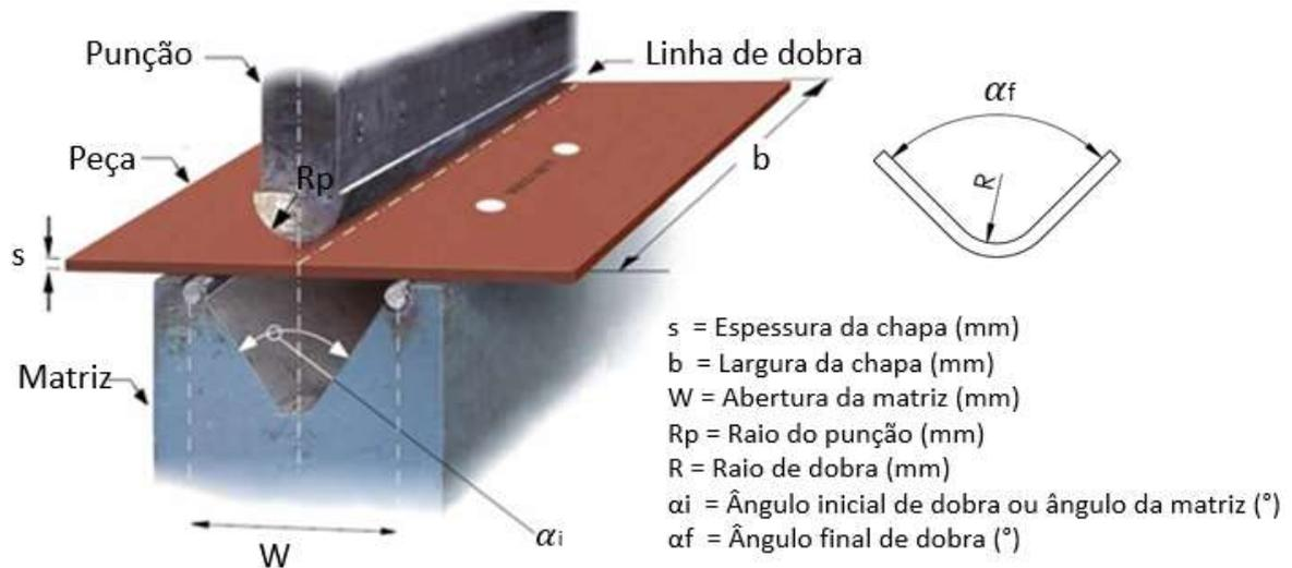
Figura 12 – Processo de dobramento de uma chapa.
