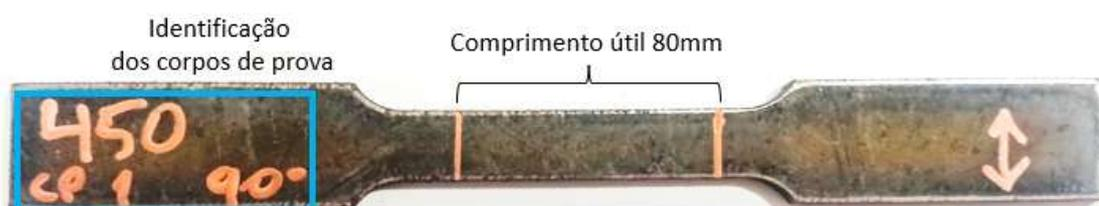
Figura 26 – Identificação dos corpos de prova de tração.
