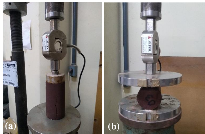
Figura 3.7 – Posicionamento do corpo de prova durante aplicação de carga: (a) RCS; (b) RTCD
