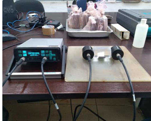
Figura 3.8 – Equipamento para determinação do módulo cisalhante inicial (PunditLab +)
