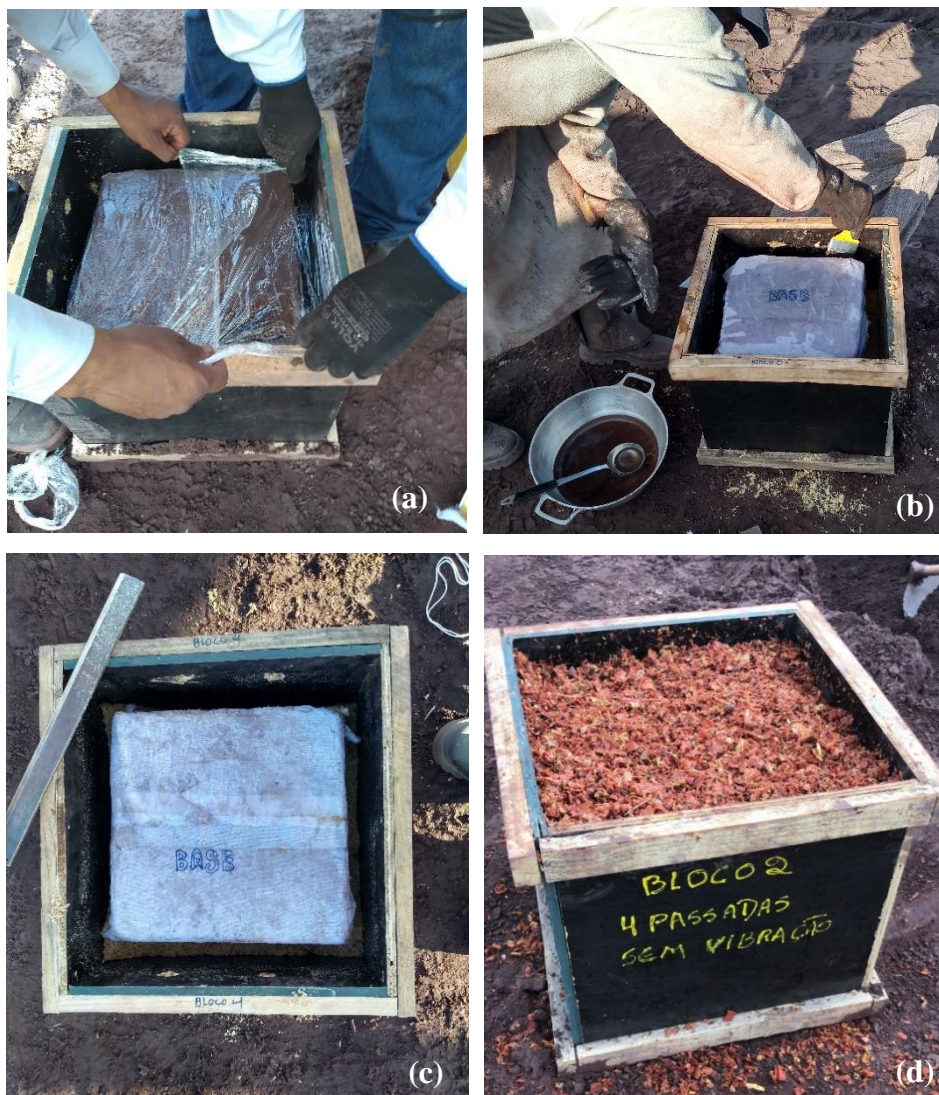
Figura 3.20 – Etapas do armazenamento das amostras indeformadas: (a) vedação da base do bloco; (b) aplicação da tela e parafina; (c) espaço livre entre caixa e bloco; (d) preenchimento do espaço livre com serragem
