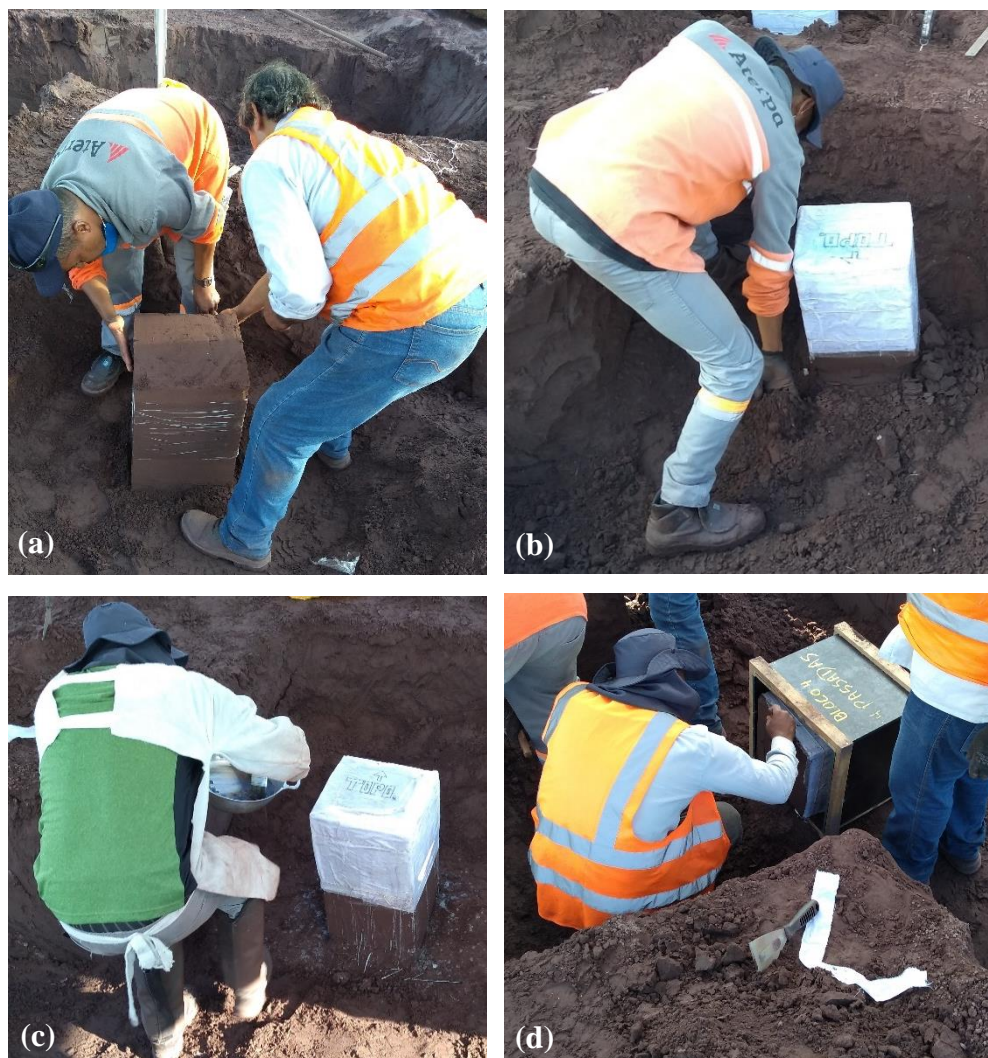
Figura 3.19 – Etapas da retirada das amostras indeformadas: (a) proteção do bloco com plástico filme; (b) proteção do bloco com tela; (c) camada de parafina; (d) extração do bloco
