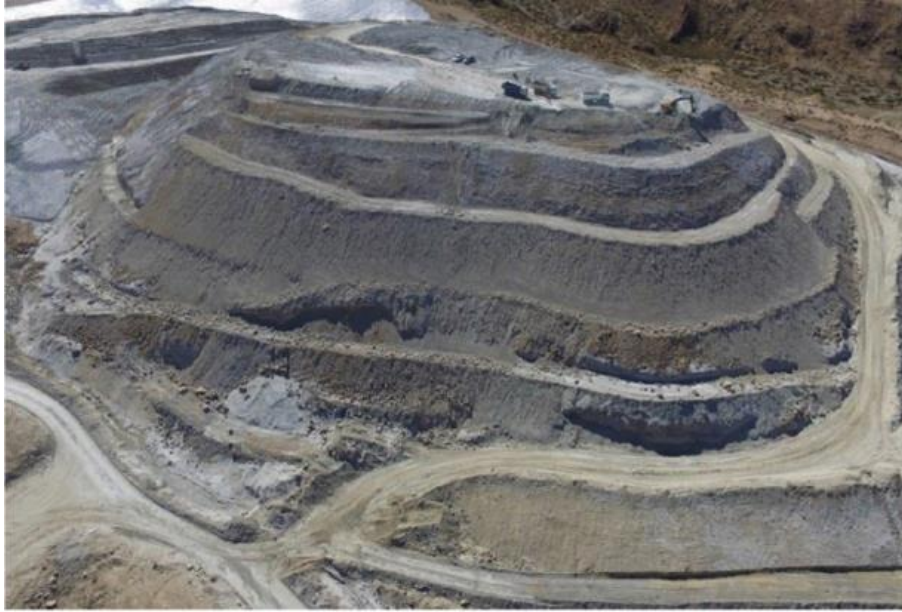
Figura 2.5 – Exemplo de pilha de rejeito filtrado, Mina Caposo, San Juan, Argentina (OLDECOP e RODARI, 2021)
