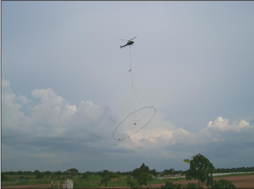
**Figura 1.5** – Levantamento aeroeletromagnético no domínio do tempo versátil (VTEM) da região *Greenstone belt* de Crixás.
