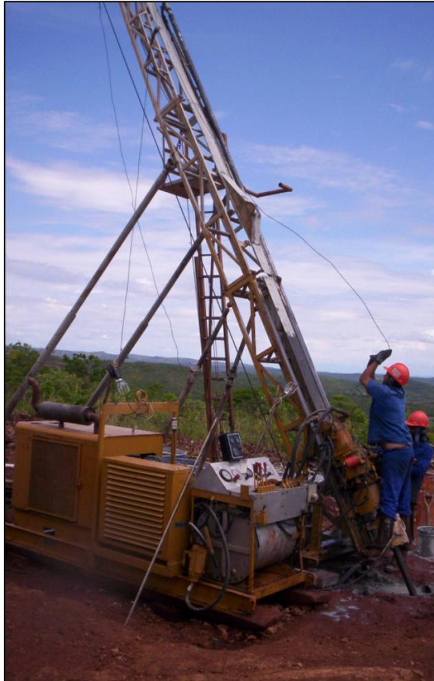
**Figura 1.6** – Sondagem rotativa diamantada realizada no Depósito de Níquel de Boa Vista.
