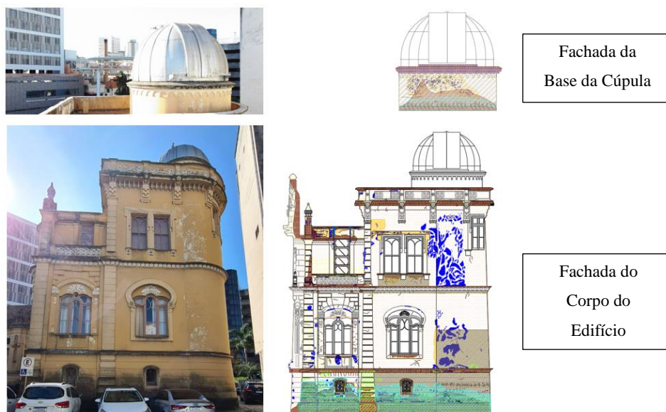
Figura 5: Desenho representativo das manifestações patológicas encontradas na fachada Sul.
