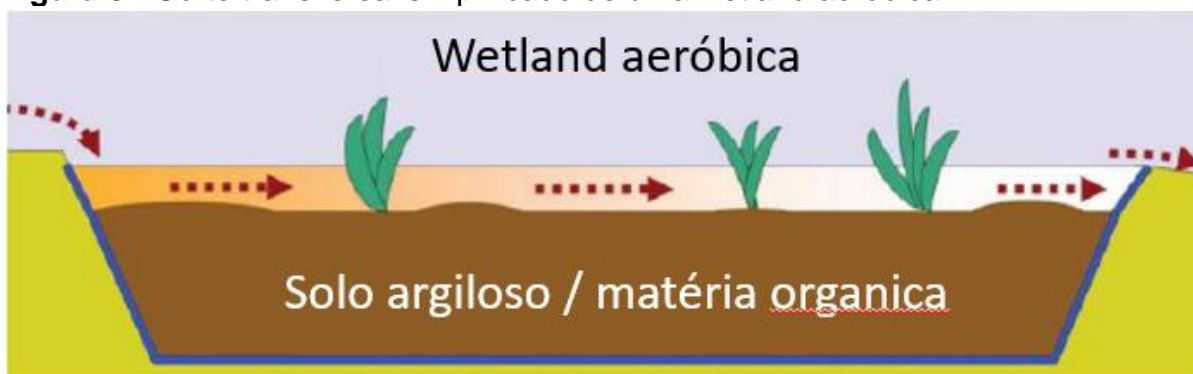
Figura 8 - Corte transversal simplificado de uma wetland aeróbica.
