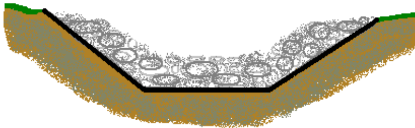
Figura 5 - Representação de um corte transversal de canais abertos de calcário.
