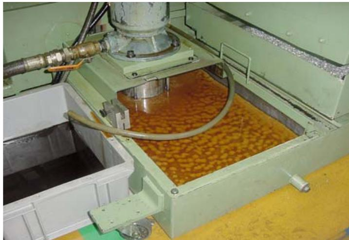
Figura 16: Skimmer utilizado para coleta do “Tramp Oil”
