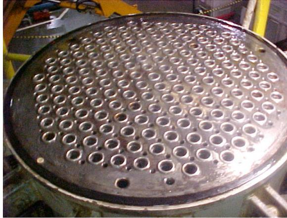
Figura 11: Foto Filtro Aluvião Parte Interior.
