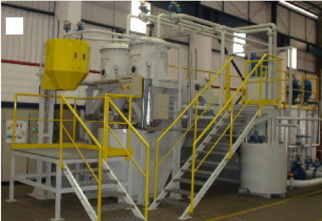
Figura 9: Foto de uma Central de Filtragem Aluvião.
