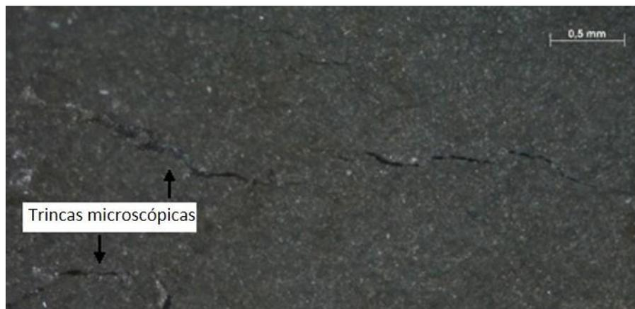
Figura 3. Imagem microscópica de trincas em revestimento real.
