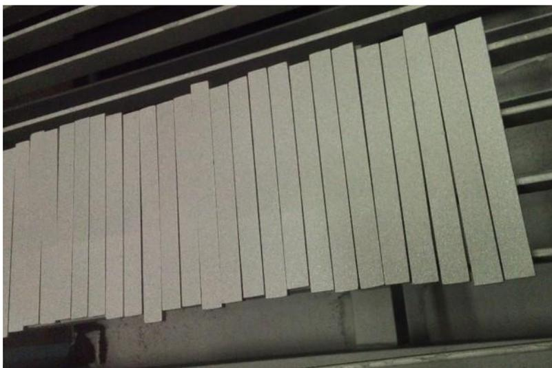
Figura 17. Corpos de prova após o processo de jateamento abrasivo.
