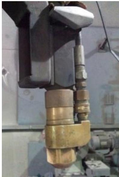
Figura 21. Pistola de HVOF usada para a obtenção do revestimento de  $\text{Cr}_3\text{C}_2\text{-25NiCr}$  sobre o aço ASTM A516.
