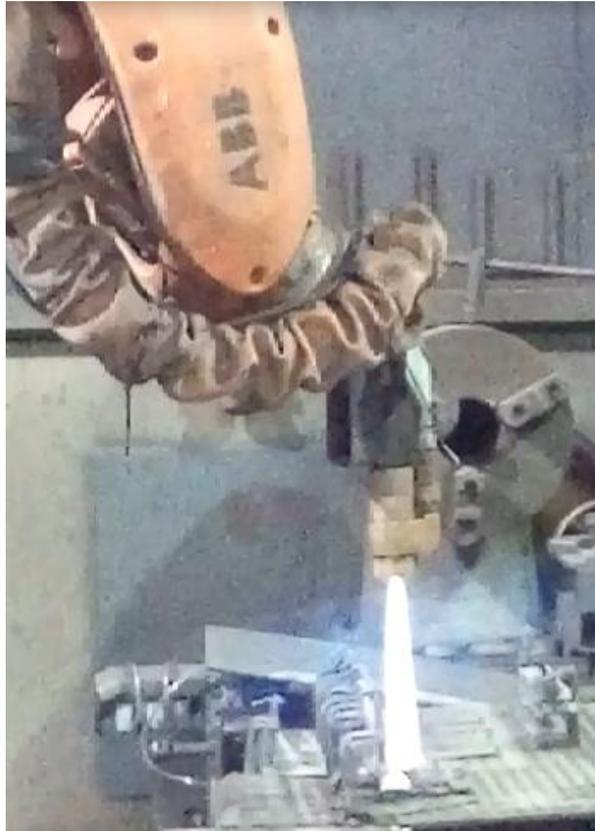
Figura 38. Foto da chama hipersônica da aplicação do pó da mistura.
