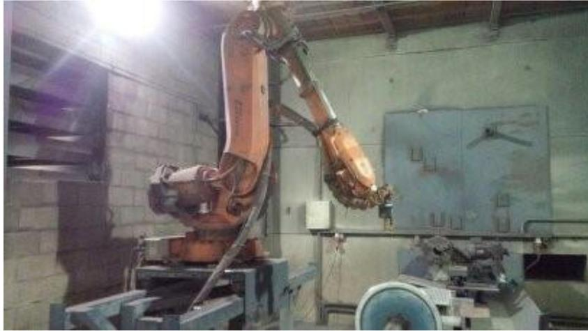
Figura 20. Braço robótico usado para a obtenção do revestimento de  $\text{Cr}_3\text{C}_2\text{-25NiCr}$  sobre o aço ASTM A516.
