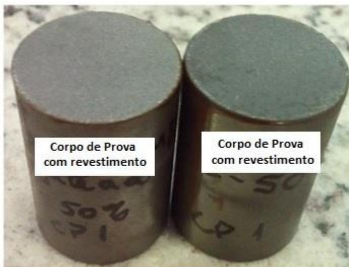
Figura 47. Corpos de prova com revestimento do pó 50% da mistura após o ensaio de aderência.
