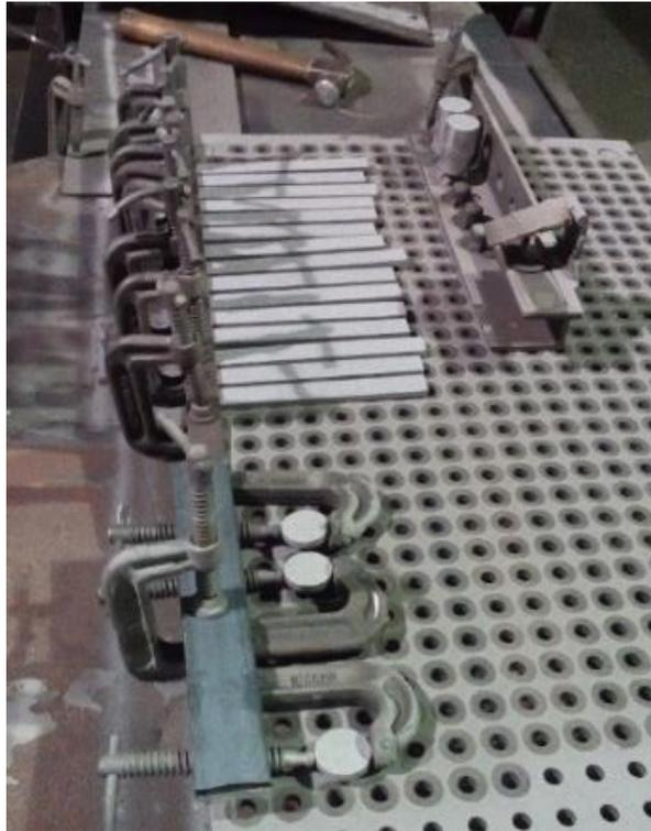
Figura 22. Posicionamento das peças para a obtenção do revestimento de  $\text{Cr}_3\text{C}_2\text{-}25\text{NiCr}$  sobre o aço ASTM A516.
