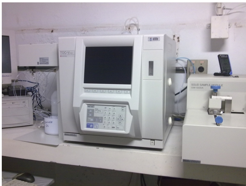
Figura 24: Equipamento de análises de Carbono Orgânico Total utilizado nos experimentos
