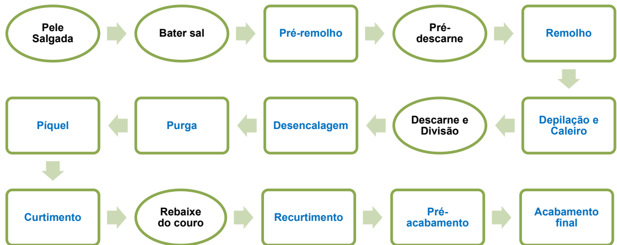
Figura 11: Fluxograma de processamento do couro (as etapas descritas em retângulos indicam que o processo ocorre em meio aquoso)
