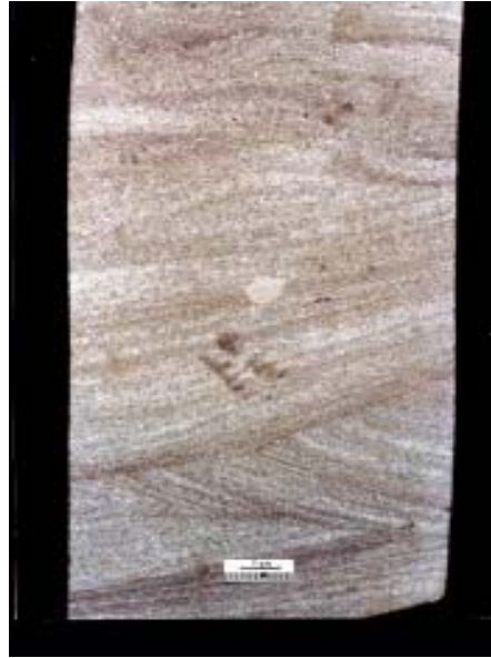
FIGURA 3.2 - Trecho de um testemunho de rocha extraídos de um poço de exploração de petróleo, utilizado para análise macroscópica.
