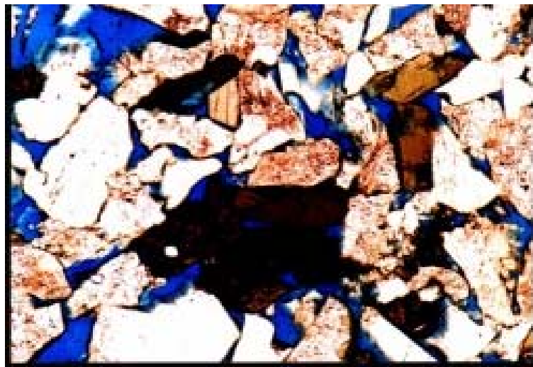
FIGURA 3.3 - Imagem de uma seção delgada de rocha sedimentar clástica, do tipo arenito, ao microscópio ótico de luz polarizada.
