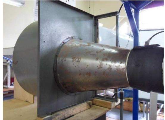
Transição no bocal de aspiração do ventilador
