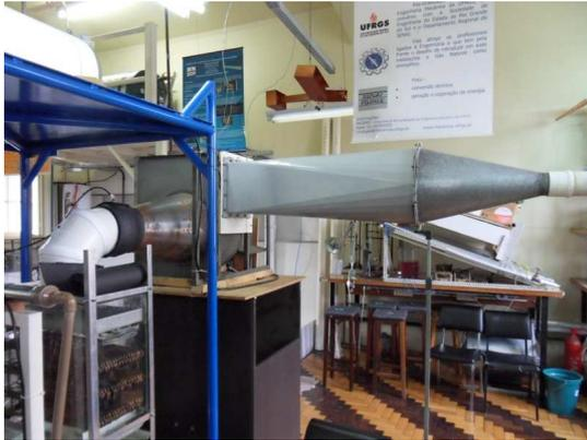
Bocal de descarga do ventilador
