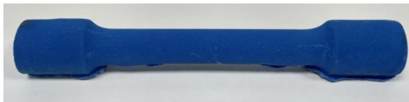
Figura 4: Corpo-de-prova isolado antes do tratamento térmico.
