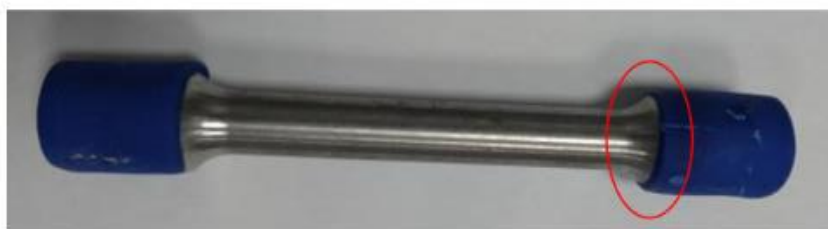
Figura 5: Corpo-de-prova com isolamento na região das cabeças.
