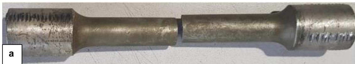
Figura 14:Corpo-de-prova cementado, temperado e revenido tracionando
