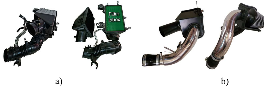
Figura 7: a) Sistema de admissão de ar original de um Civic Si 2008; b) Short Ram Intake de um Civic Si 2008.
