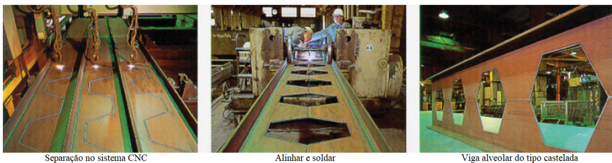
Figura 1.1 – Processo de fabricação de vigas alveolares (GEMPERLE, 2007)
