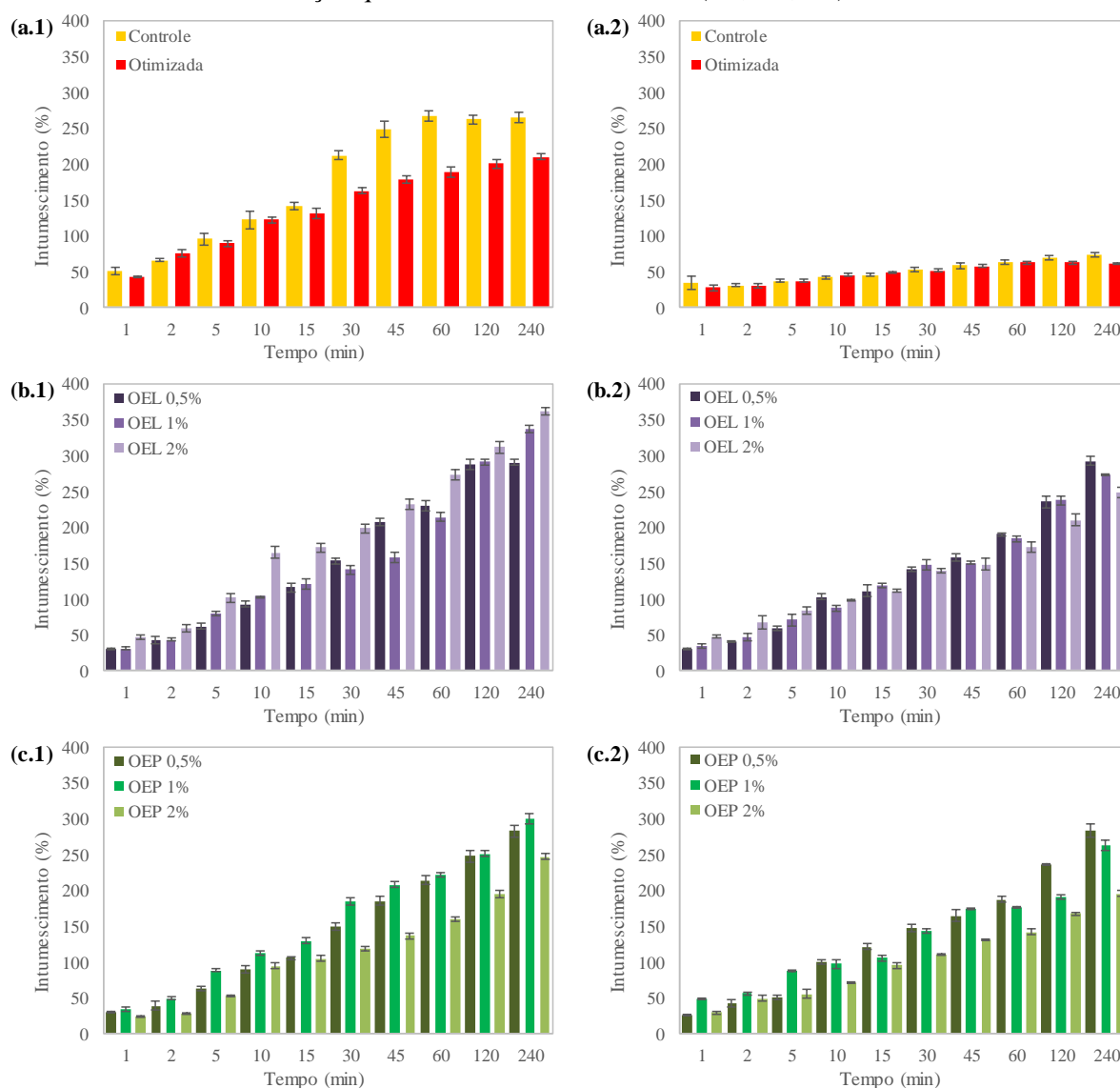
Figura 4.15 – Cinética de intumescimento dos filmes de hidrogel controle, otimizado e contendo óleos essenciais de lavanda (OEL) ou pinheiro silvestre (OEP) em água destilada (a.1, b.1 e c.1) e em solução que simula exsudato de ferida (a.2, b.2, c.2).
