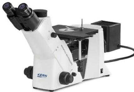
Figura 55 – Imagem ilustrativa do microscópio metalúrgico invertido Olympus GX51.
