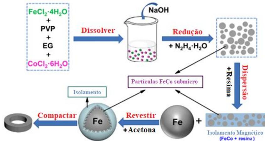
Figura 20 – Esquemático para a preparação de revestimento de SMCs à base de Fe com camada isolante contendo resina.
