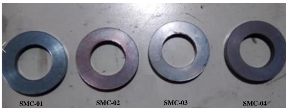
Figura 46 – Resultado da sinterização dos corpos de prova das amostras SOM-01 a SMC-04.
