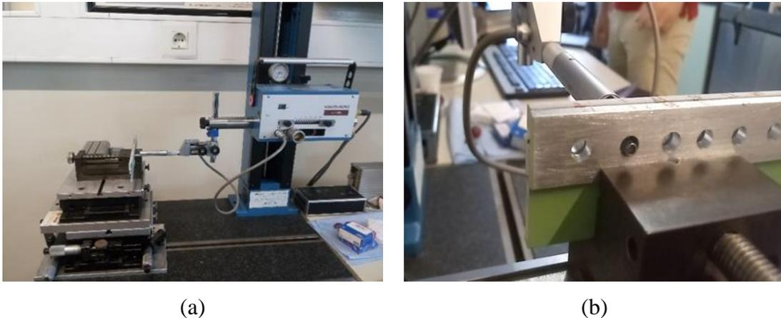
Figura 4.8 – Aquisição de dados de rugosidade média: (a) perfilômetro e apalpador; (b) exemplo de medição na saída do furo da junta composta (Etapa 2).
