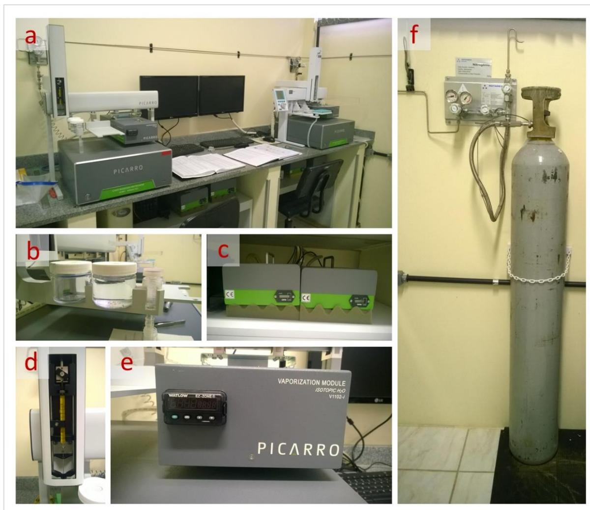
**Figura 37.** Fotos dos dois sistemas PICARRO L2130-i do Laboratório de Isótopos Estáveis do CPC/UFRGS (a). A foto (b) mostra a estação de limpeza da seringa, a (c) as bombas, (d) detalhe da parte do autoamostrador onde fica a seringa, (e) o vaporizador PICARRO V1102-i e (f) o sistema de gás nitrogênio. Fonte: da Autora.
