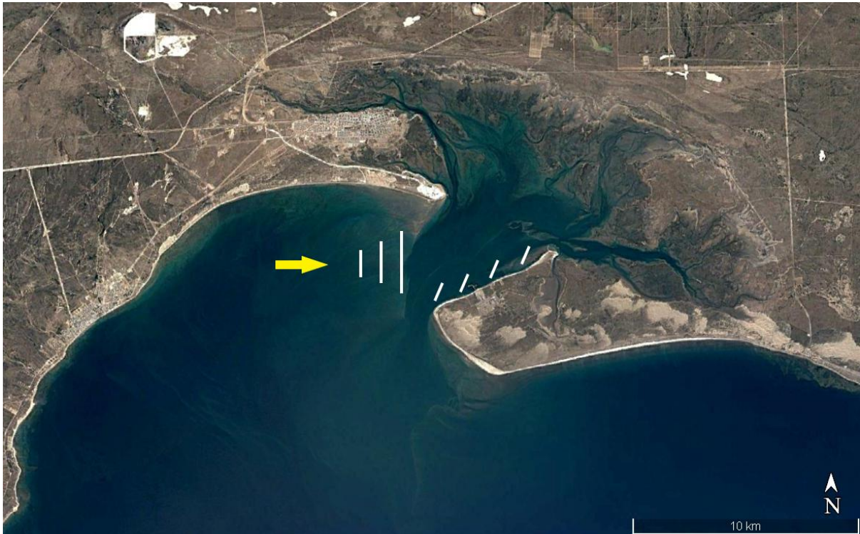
Figura 21. Imagem (© Google Earth Pro, 2022) mostrando o quadrante da direção da onda dominante da Bahía San Antonio de oeste, e a refração das ondulações pela interação com face norte da Península Villarino.
