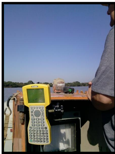
Figura 45: Ecobatímetro e receptor GNSS utilizados no levantamento batimétrico
