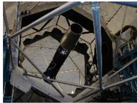
Vista do telescópio Keck I a partir do alto da sua cúpula. Além da estrutura de suporte, vemos claramente o espelho segmentado de 10m, que contém 36 peças hexagonais. A luz incide neste espelho primário e é refletida para o secundário, o qual fica dentro do tubo metálico no centro da foto. Do secundário, a luz, então, é enviada novamente para baixo, ao longo do eixo central do telescópio, até os instrumentos de análise. Fonte: http://keckobservatory.org/gallery
