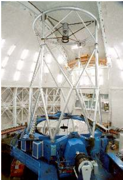
Um dos dois telescópios Gemini, com espelho primário de 8m de diâmetro, visto do alto da cúpula. O furo no centro do primário capta a luz refletida pelo secundário, que fica no alto do telescópio. O Brasil participa do consórcio Gemini podendo utilizar tanto o que está no Havaí (na foto), quanto o que está no Chile. Fonte: http://gemini.physics.ox.ac.uk/photos/geminin-telescope-hr.tif
