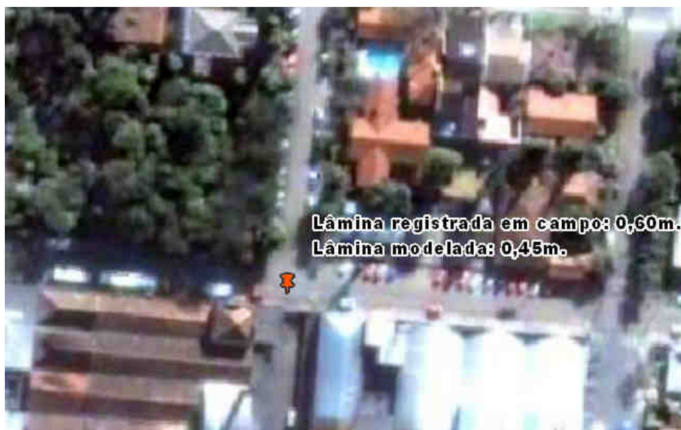
Figura 67 – Ilustração do Ponto 4: erro altimétrico de 0,15m na modelagem. (Ponto referente à Figura 68)
