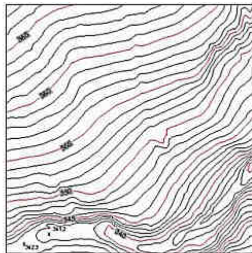
Figura 6 – Exemplo de representação da altitude por curvas de nível.
