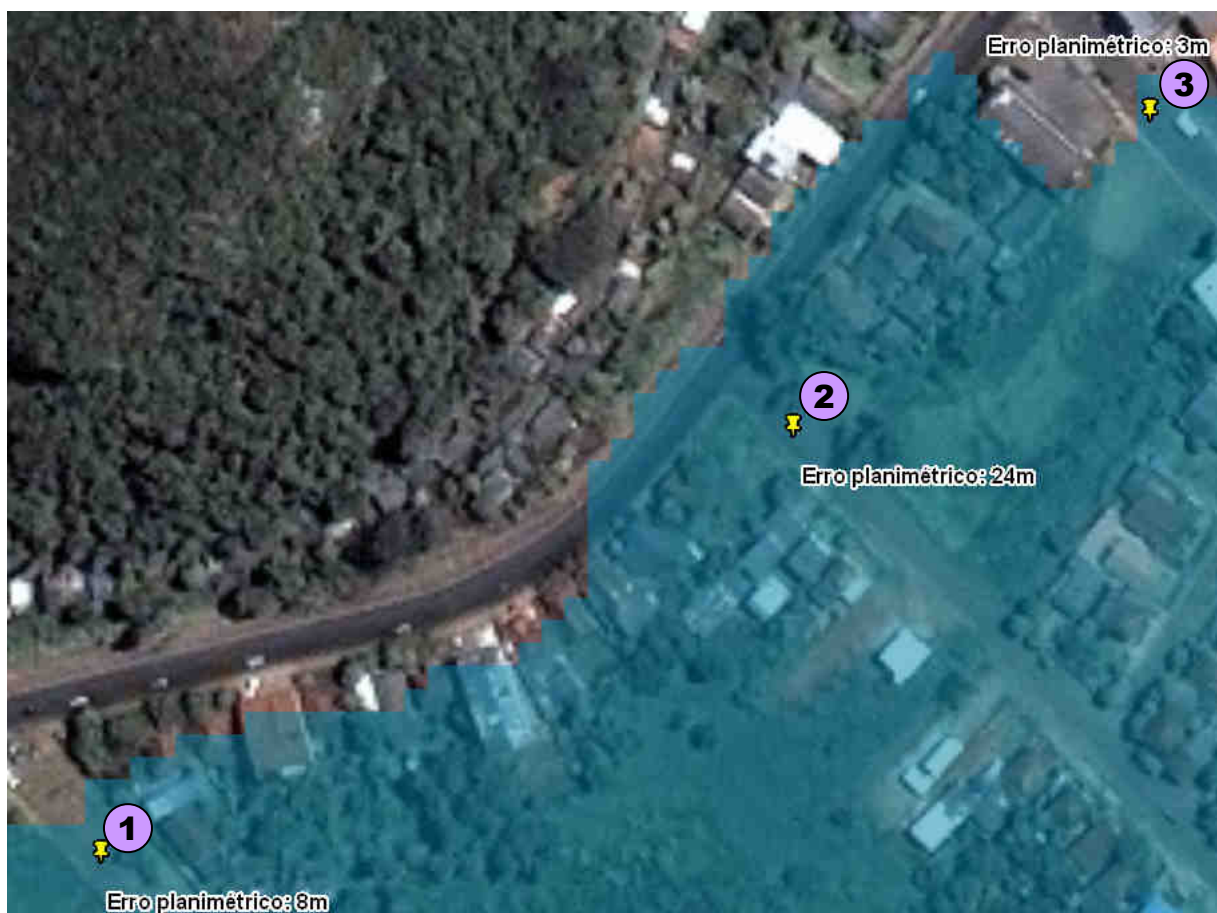
Figura 119 – Pontos de avaliação nº 1, 2 e 3: erro planimétrico de 8m, 24m e 3m na modelagem da inundação de 25/09/2007.
