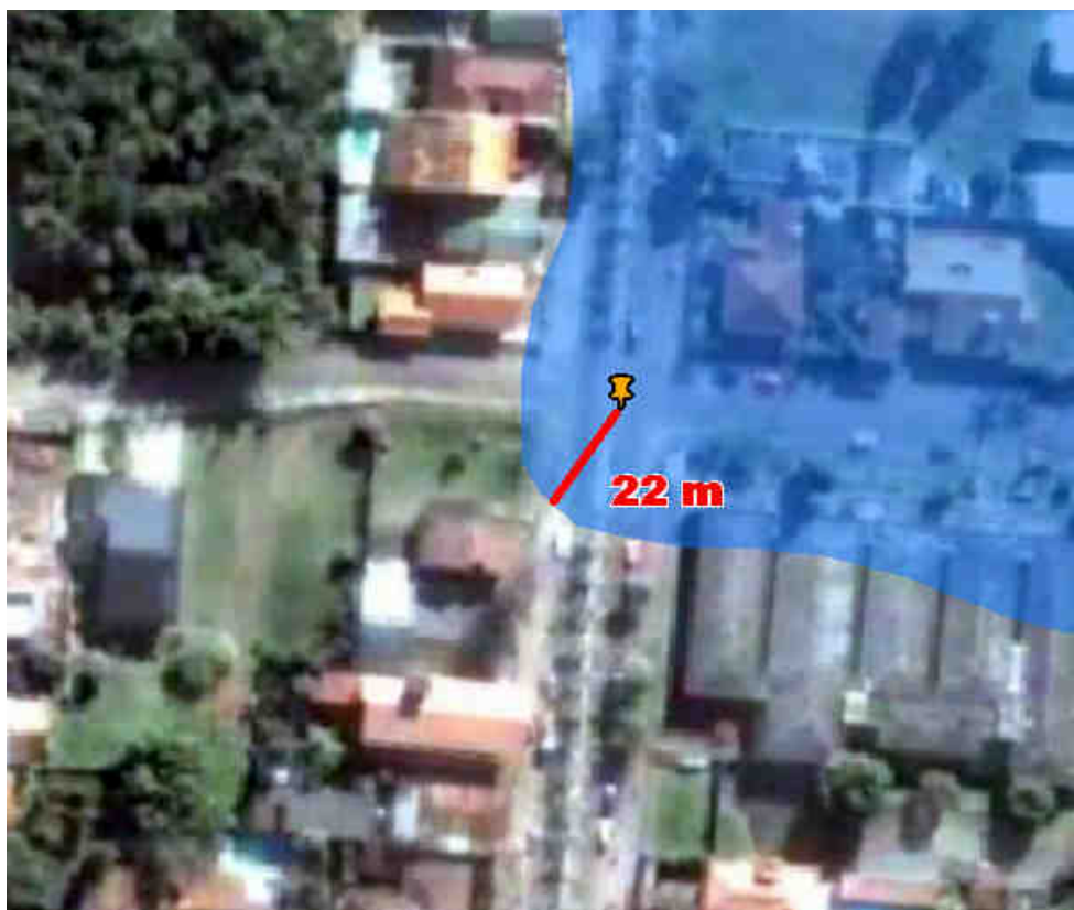
Figura 64 – Ilustração do Ponto 1: erro planimétrico de 22m na modelagem.
