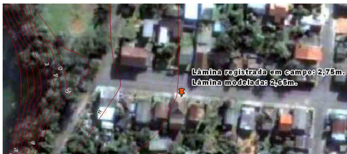
Figura 66 – Ilustração do Ponto 3: erro altimétrico de 0,10m na modelagem. (Ponto referente à Figura 46)
