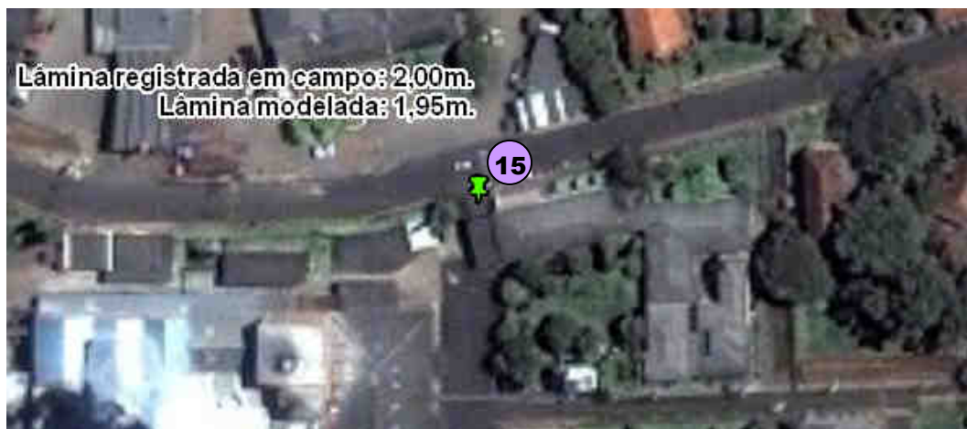
Figura 121 – Ponto de avaliação nº 15: erro altimétrico de 0,05m na modelagem da inundação de 25/09/2007.
