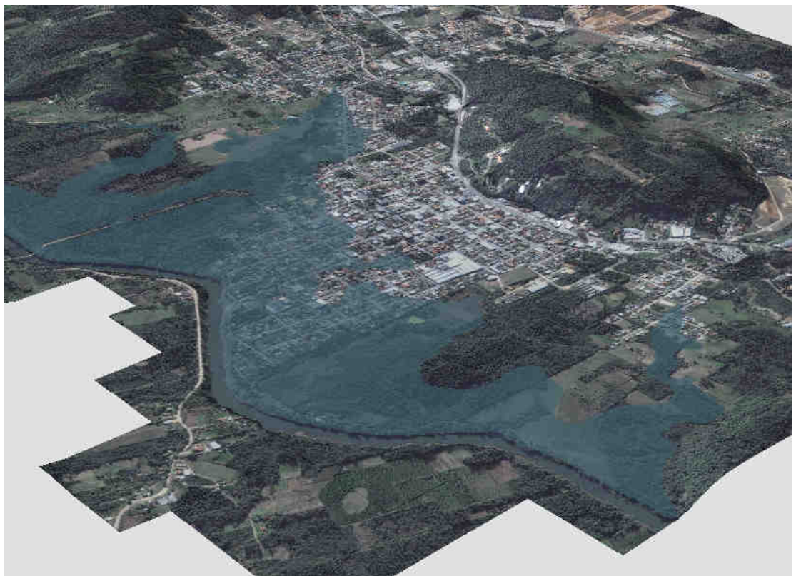
Figura 57 – Cenário de áreas inundáveis com TR de 5 anos em São Sebastião do Caí.
