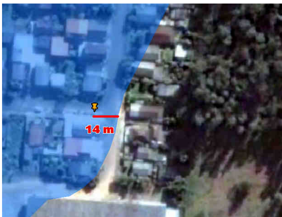
Figura 65 – Ilustração do Ponto 2: erro planimétrico de 14m na modelagem.
