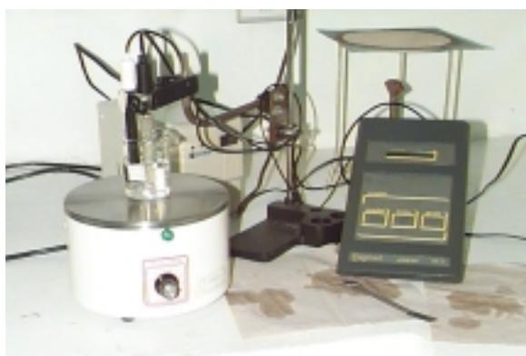
Figura 8.4 Determinação da concentração de cloretos através do eletrodo de íon seletivo (HOFFMANN, 2001)
