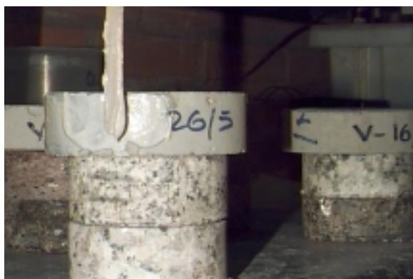
Figura 8.2 Fatia de 2,5 cm retirada da parte central do corpo-de-prova revestida com resina epóxi (HOFFMANN, 2001)
