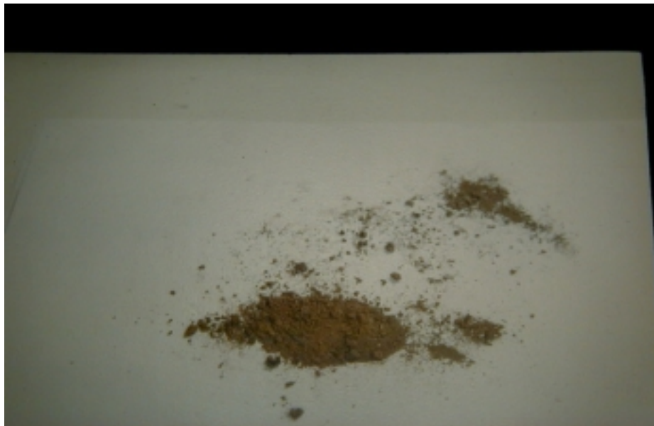
FOTO 5.2 Cinza de Lodo Sanitário da ETE IAPI destorroada
