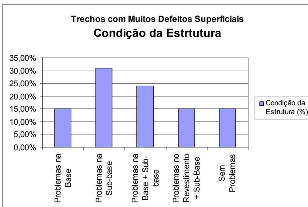
Figura 5.10 – Condições da estrutura dos pavimentos para os trechos com Muitos Defeitos Superficiais
