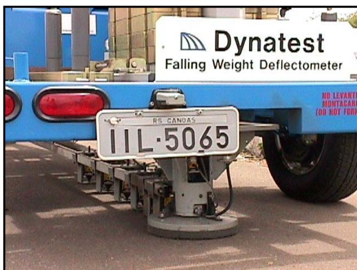
Figura 2.9 – Deflectômetro de impacto Falling Weight Deflectometer – no campo
