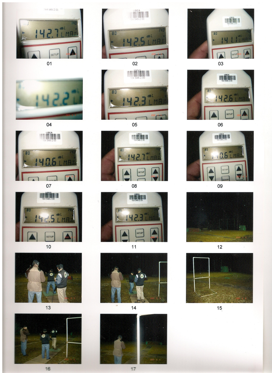
Figura 7b - Decibelímetro Quest model 1900(UFRGS) medindo Ruído de Impacto de armas calibre 12. ( média de vários shots : 142,0 dB – Clube Socapesca/Viamão)
