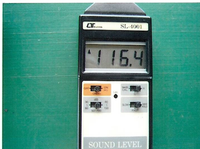
Figura 7a - Decibelímetro LUTRON SL-4001 (UFRGS) medindo Ruído de Impacto de armas calibre 12. ( média de vários shots : 116,4 dB )
