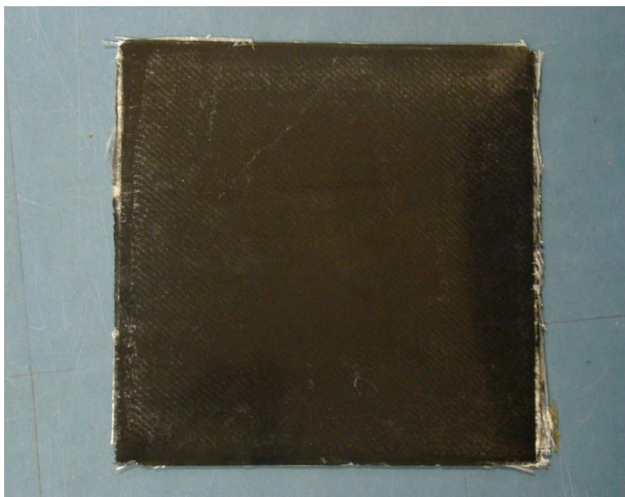
Figura 17 – Placa de compósito tricomponente moldada por RTM
