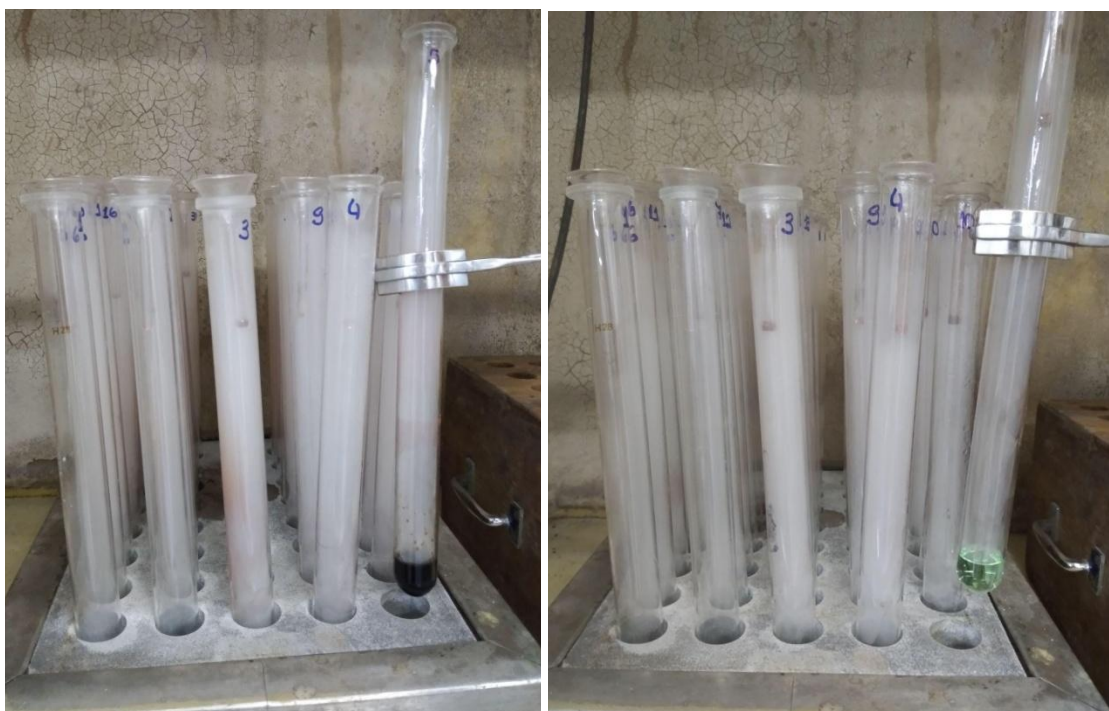
Figura 2. Processo de digestão no bloco digestor e a mudança de coloração da solução que ocorre o processo.
