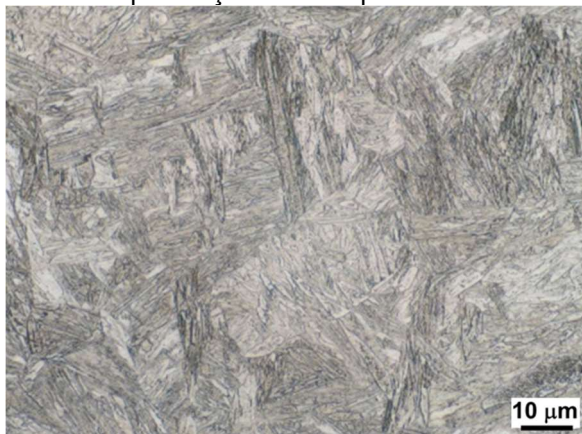
Figura 58 - Amostra austenitizada em 1200 °C e resfriada a 20 °C/s até a temperatura ambiente. Sem presença de ferrita pró-eutetóide.
