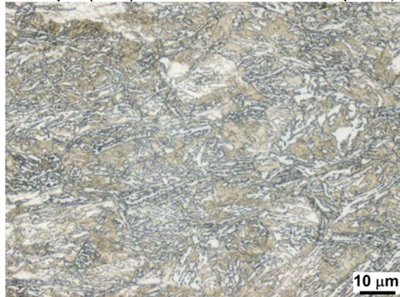
Figura 77 - Metalografia Teste 17: TA: 950 °C / TD: 950 °C (20 %) + 500 °C (20%) / Grau de Deformação (total): 40% / Taxa de Deformação: 0,1s -1 .
