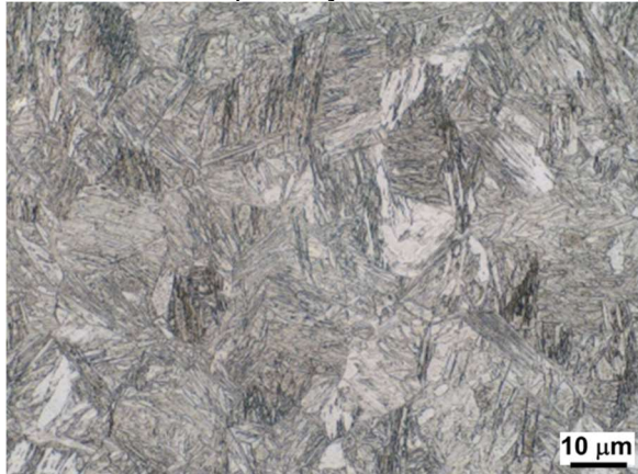
Figura 54 – Amostra austenitizada em 870 °C e resfriada a 20 °C/s até a temperatura ambiente. Sem presença de ferrita.
