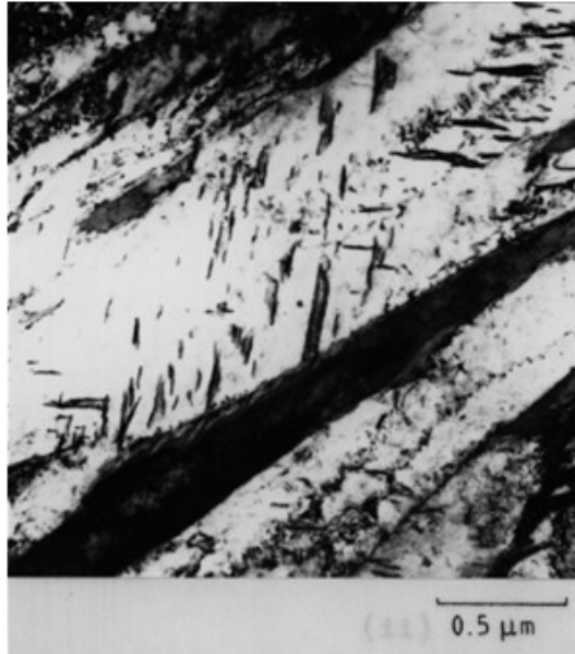
Figura 9 - Microestrutura da bainita inferior. Observa-se diversas partículas de carbonetos no interior da ferrita bainítica.
