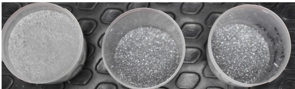
**Figura XIX** - Frações resultantes da separação eletrostática. Fonte: próprio autor.
