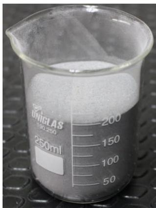
**Figura XVIII** - Resultado da fração fina após separação granulométrica.
