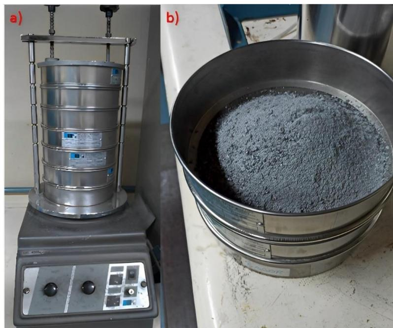
**Figura XV** - Agitador de peneiras da marca Bertel. a) Equipamento em operação. b) Material fragmentado pelos moinhos antes de ser classificado. Fonte: próprio autor.
