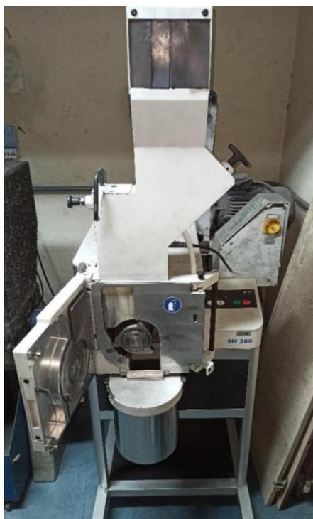
**Figura XIV** - Moinho de facas SM3000 da marca Retsch. Foi utilizado na segunda moagem com uma peneira de 1 mm de abertura. Fonte: próprio autor.
