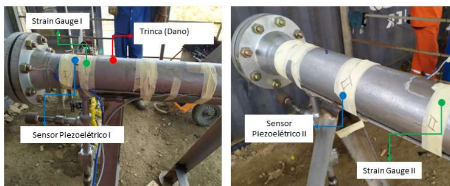
Figura 3.7.1.1 - Arranjo da instrumentação instalada para a aquisição dos sinais de emissões acústicas [Autor, 2022].
