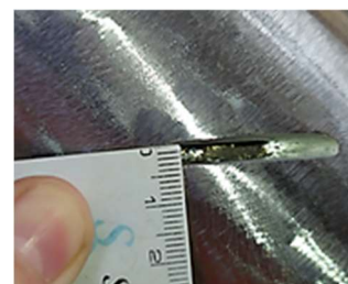
Figura 3.4.4 – Largura da trinca imposta [Autor, 2022].
