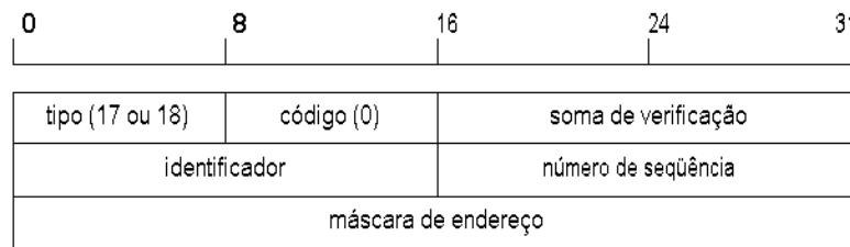
FIGURA 3.14 - Mensagem ICMP de obtenção de máscara de endereçamento
