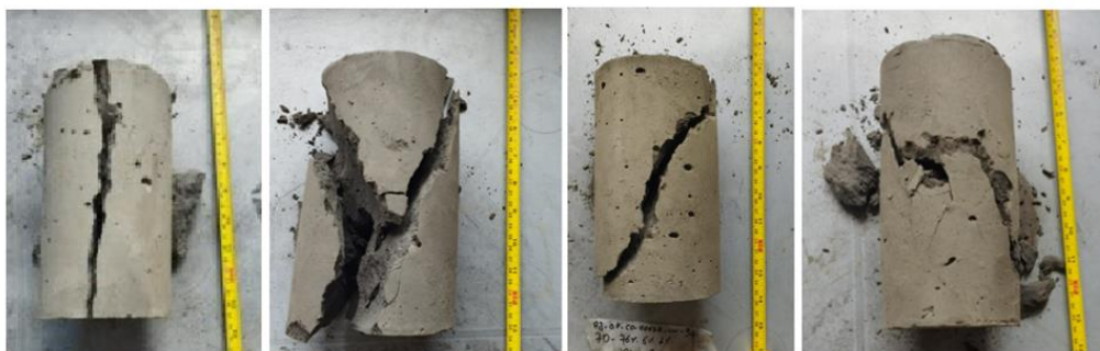
Figura 37 - Ensaios validados – De acordo com ASTM C39 (2003).
