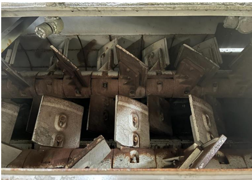
Figura 14 - Interior do misturador com sistema de pás.
