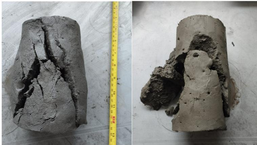
Figura 60 – Amostras rompidas com pouca rigidez – retardamento de cura.
