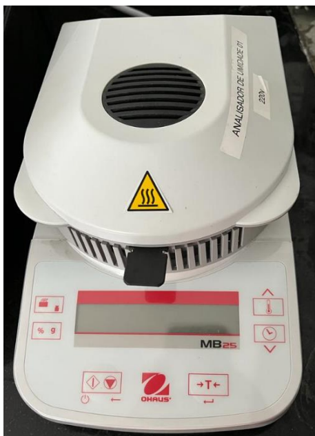
Figura 33 - Analisador de umidade.
