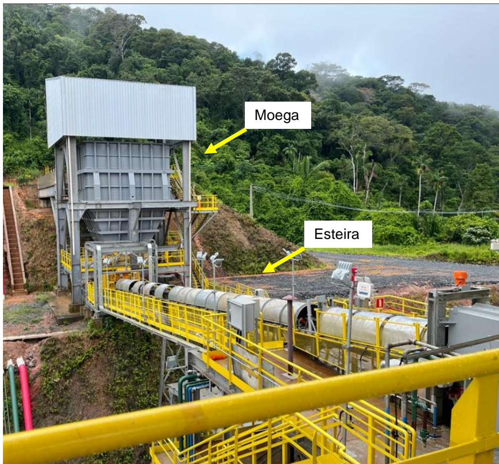
Figura 9 - Moega de descarga e esteira de transporte.
