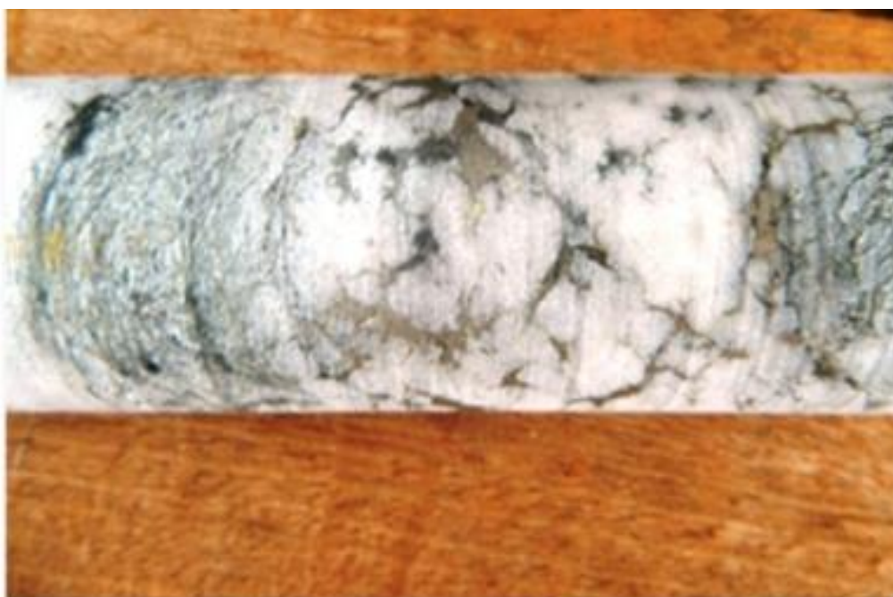
Figura 4 - Ocorrência de sulfetos em veio de quartzo.
