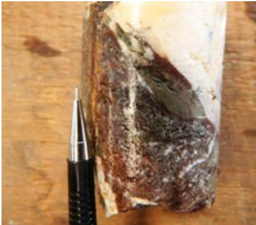
Figura 3 - Falha em testemunho de sondagem
