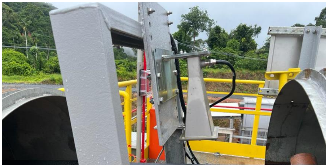
Figura 10 - Sensor de umidade instalado na correia transportadora.
