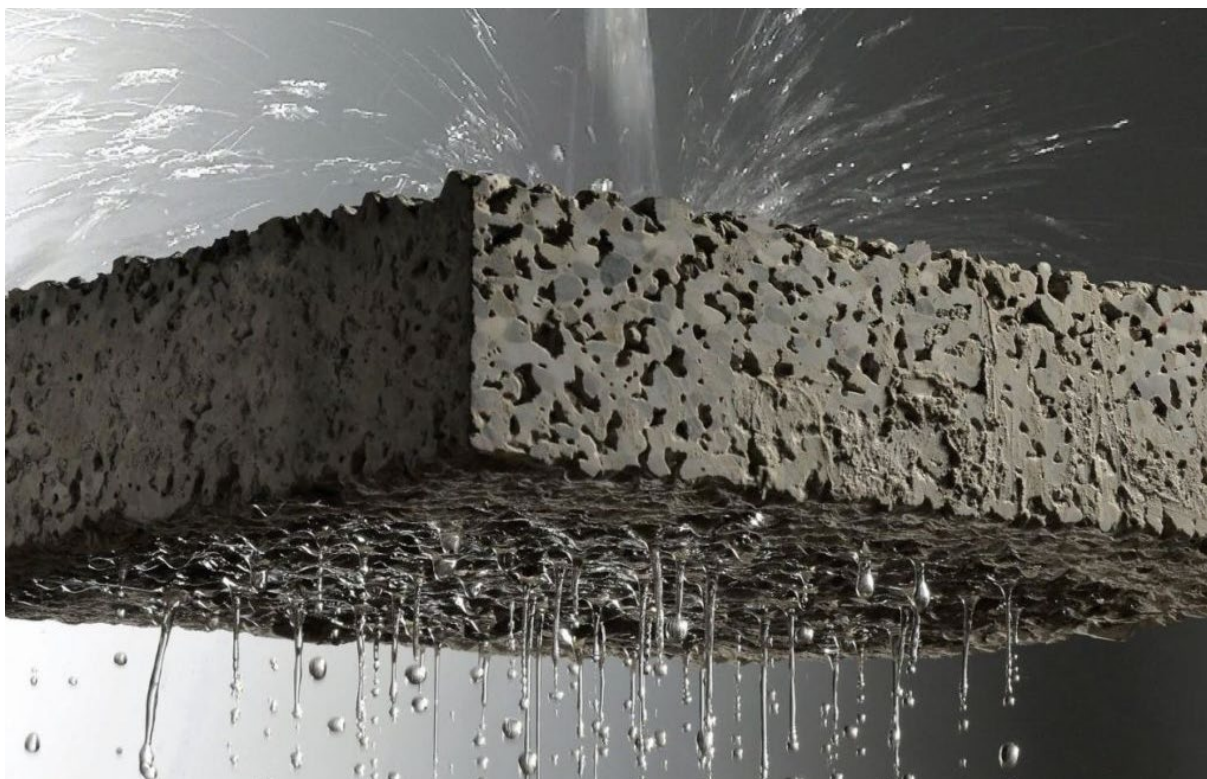
Figura 9 - Pavimento de concreto permeável.
