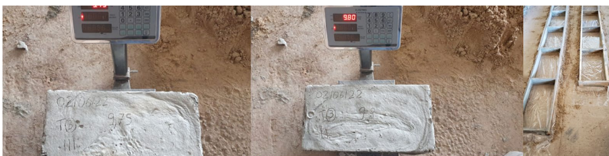
Figura 32 - Teste do BCCE e Moldagem.
