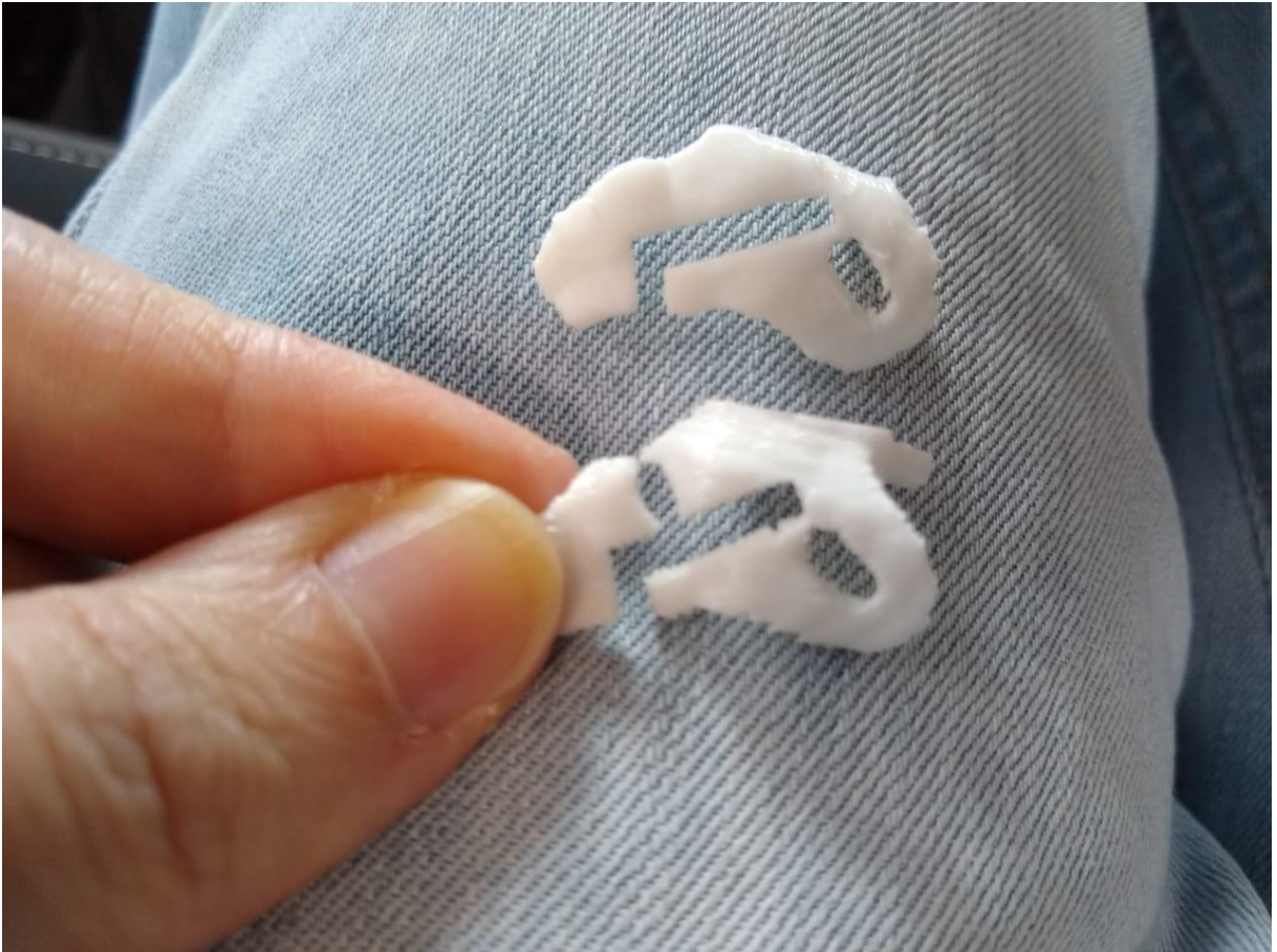
Figura 87. Impressão quebrada devido ao tamanho
