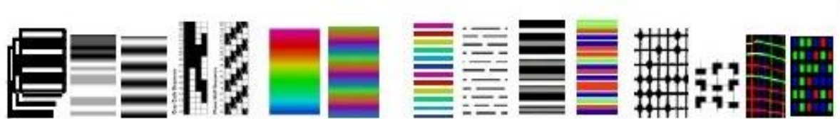
Figura 27. Tipos de projeção para luz estruturada
