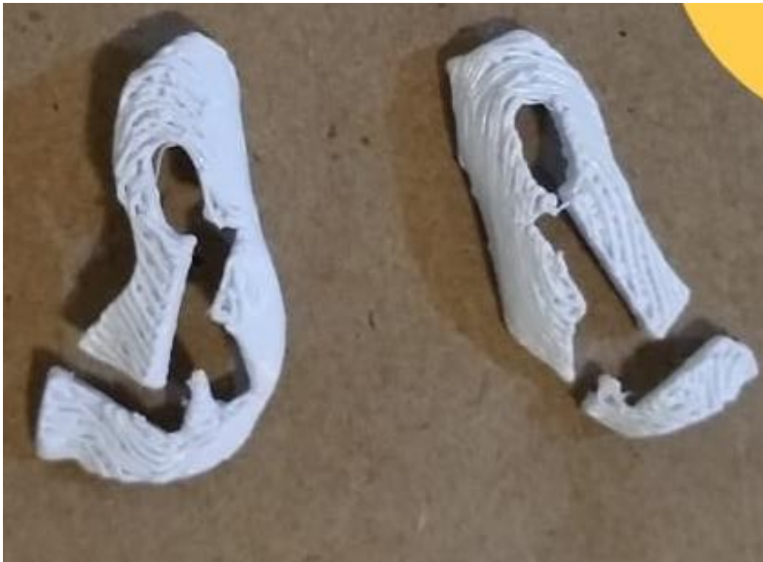
Figura 91. Quebra do gabarito impresso
