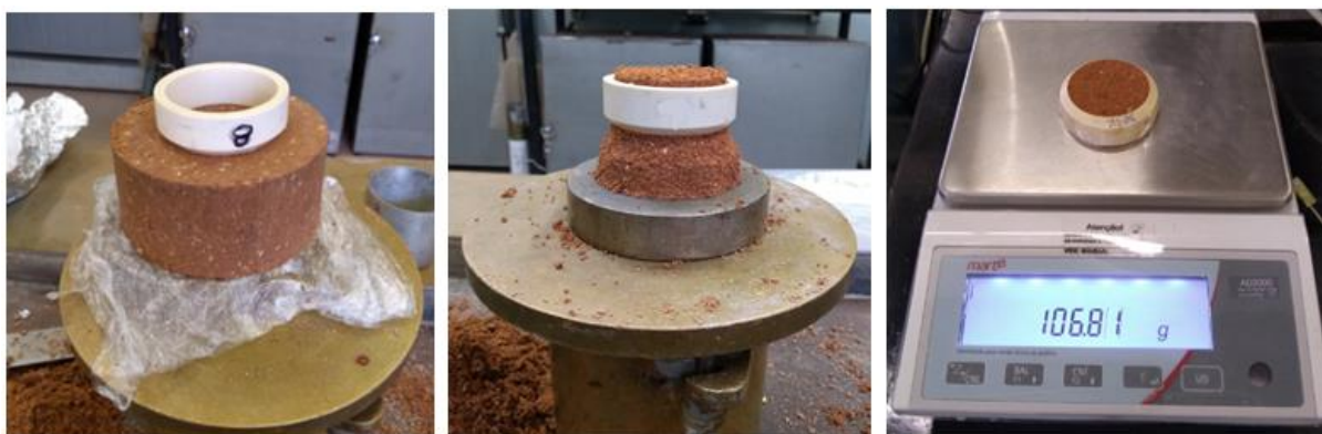
Figura 3-6 – Amostra de solo sendo esculpida com o auxílio do anel de PVC
