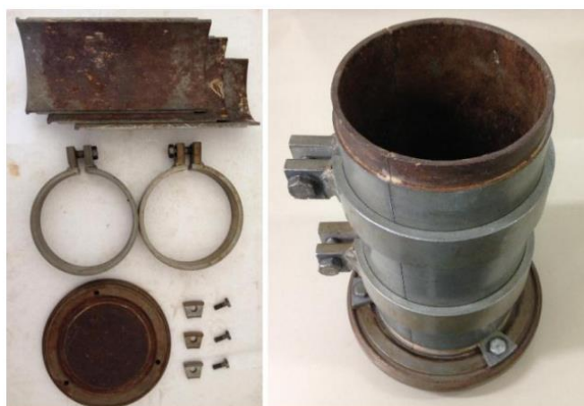
Figura 3-9 – Molde utilizado para a moldagem dos corpos de prova
