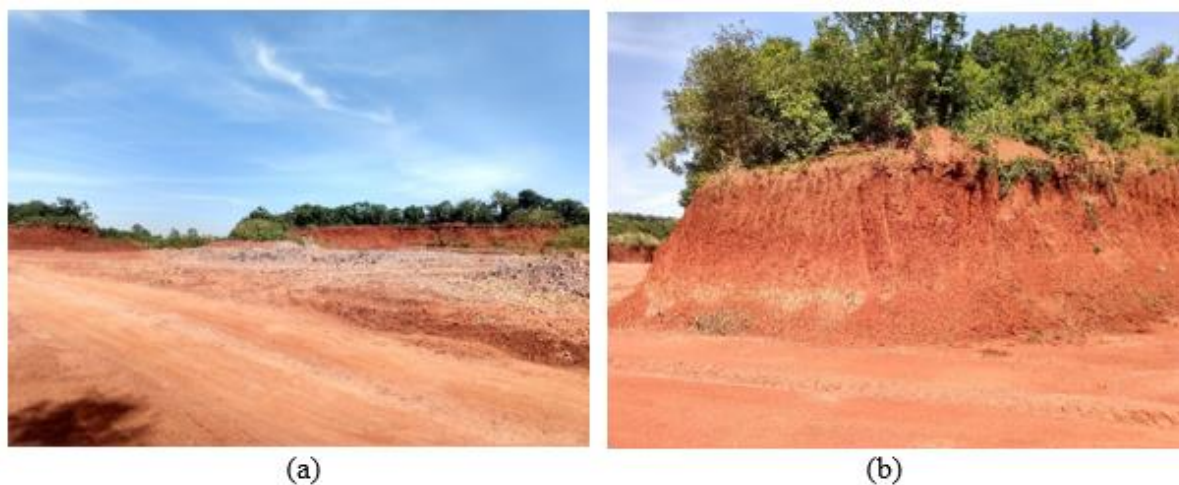
Figura 3-4 - Jazida do solo AS localizada em Gravataí/RS: (a) panorama geral da jazida, (b) perfil estratigráfico do solo
