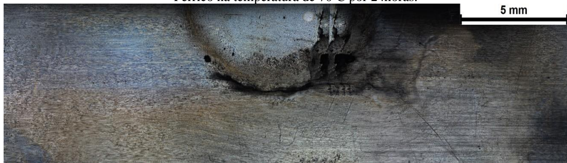
Figura 5.37 - Imagem da face superior da amostra utilizada para o ensaio de imersão em Cloreto Férrico na temperatura de 70°C por 24horas.
