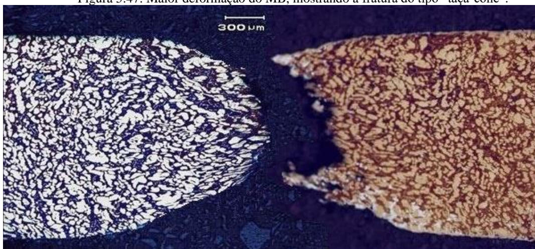
Figura 5.47. Maior deformação do MB, mostrando a fratura do tipo “taça-cone”.
