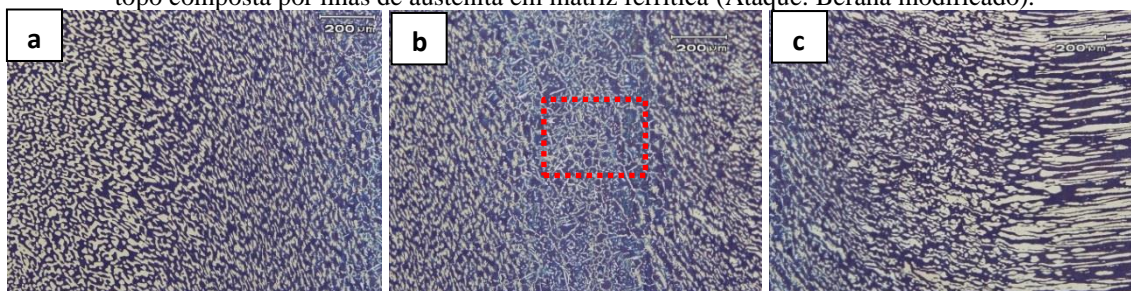
Figura 5. 12 - Metalografias mostrando (a) a região central do pino processado de topo (b) a região da ZTMA-recristalizada contendo a interface de solda e (c) a microestrutura do material de base de topo composta por ilhas de austenita em matriz ferrítica (Ataque: Beraha modificado).
