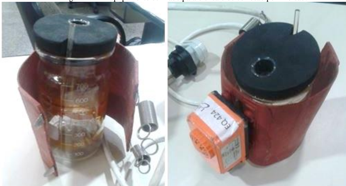
Figura 4. 14- Equipamento utilizado para o ensaio de corrosão por imersão.
