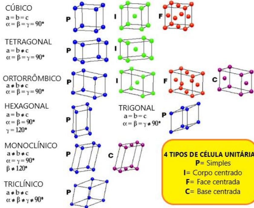
Figura 15: Os sete sistemas cristalinos e as 14 redes de Bravais. Fonte: MASCARENHAS, 2020 (Adaptado).<sup>73</sup>
