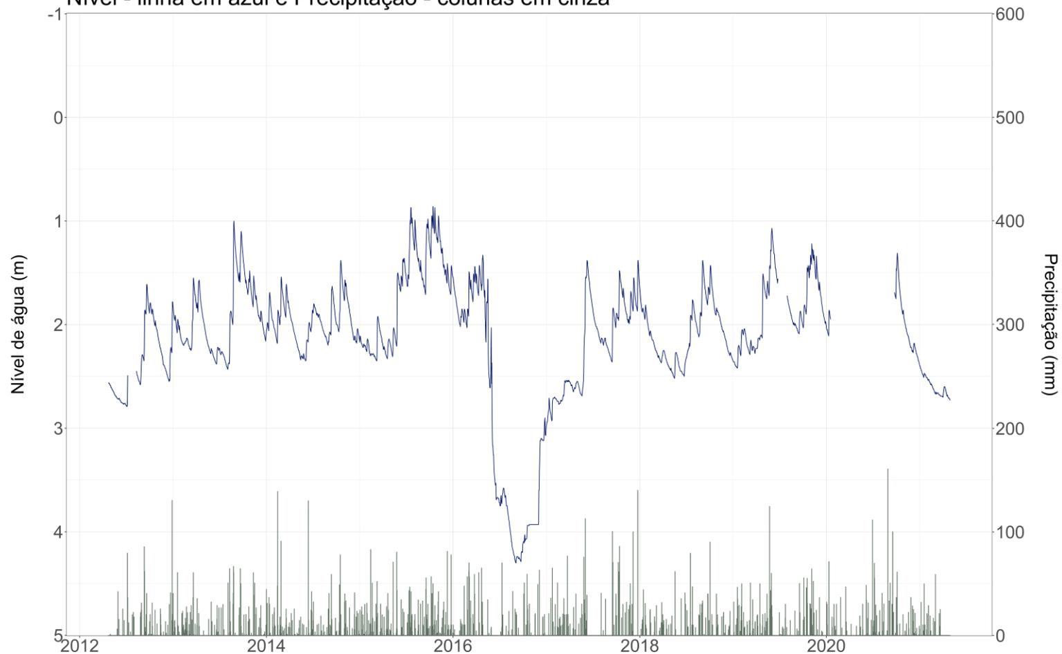
**Figura – Gráfico de nível e precipitação para o poço 4300020528.**
