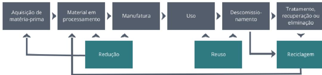
Figura 10 - Diagrama de fluxo de processo das fases do ciclo de vida para painéis fotovoltaicos e oportunidades resultantes para redução, reutilização ou reciclagem (Adaptado de IRENA, 2016).
