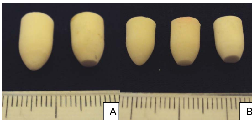
Figura 54 - Comparação visual entre as amostras antes e depois do teste de PPD. Em A) ALC02. Em B) inserto virgem, ZPC02 e ZTC02, da esquerda para a direita.
