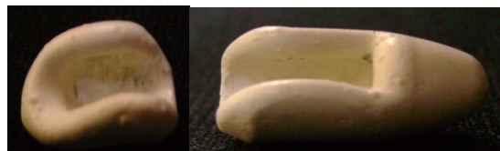
Figura 58 - Exemplos de problemas encontrados durante a etapa de conformação dos insertos cerâmicos.
