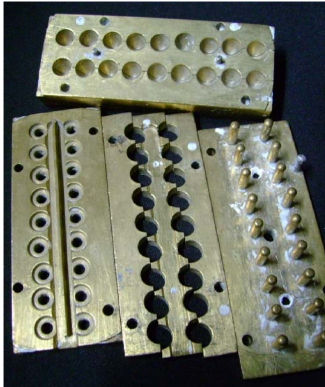
Figura 57 - Matriz de latão de 20 cavidades em formato de ponteiras para injeção em baixa pressão.
