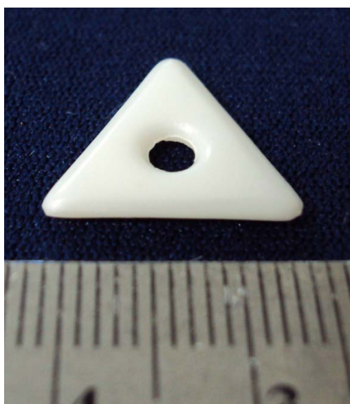
Figura 62 - Pastilhas de zircônia parcialmente estabilizada para uso em pigs multi-size.
