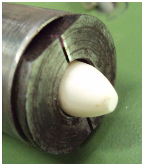
Figura 52 - Amostra de alumina ALC02 após ensaio de 16 h.
