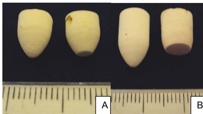
Figura 55 - Comparação visual entre as amostras antes e depois do teste de PPD. Em A) ALZC02. Em B) MUC02.
