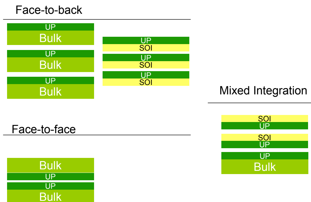
Figura 2.3: Estratégias de integração face-to-back , face-to-face e mixed integration com tecnologias bulk e SOI.
