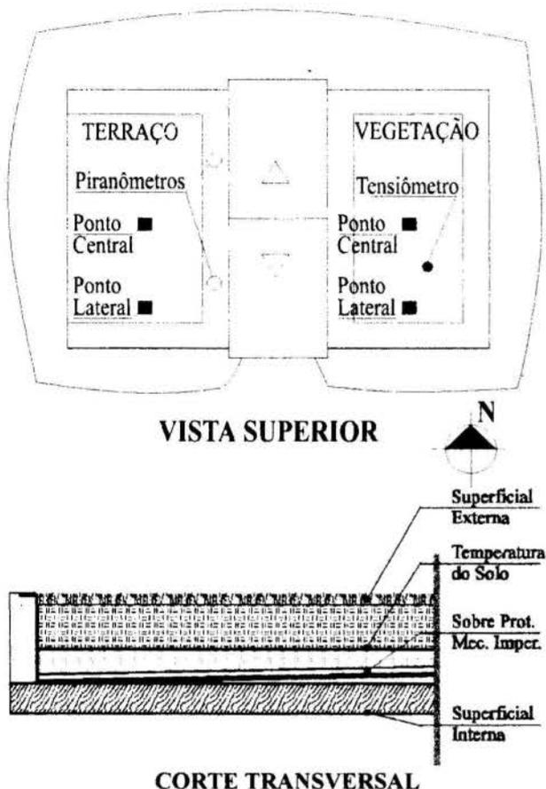
Figura 3 - Pontos de instalação dos sensores
