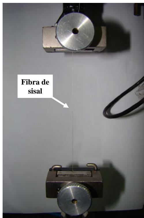
Figura 16 – Garras para filmes utilizadas nos ensaios de tração das fibras.
