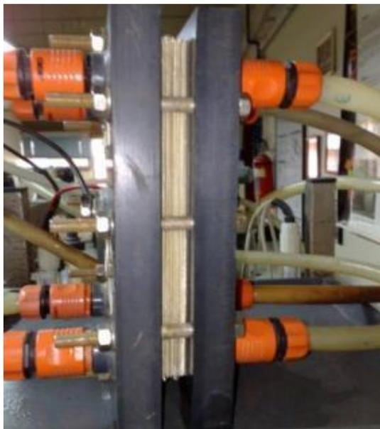
Figura 3 – Módulo de placas planas utilizado em sistema de ED do LACOR-UFRGS.
