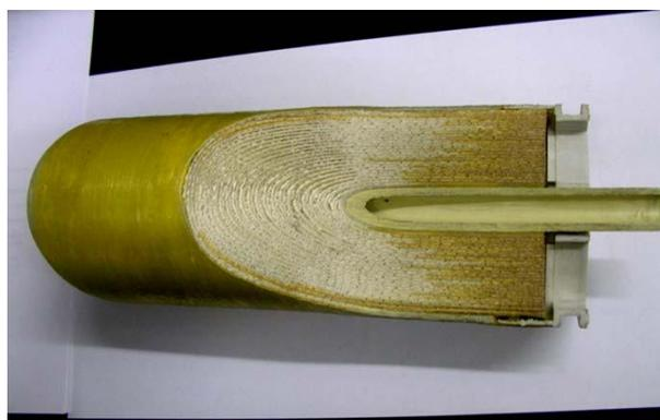
Figura 6 – Corte de um módulo espiral (RADJENOVIC *et al.*, 2008).
