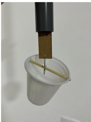
Figura 3 (b): Dinamômetro Construído
