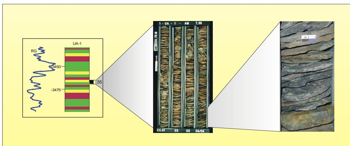
Fig. 6.4 – Litofácies S1: Siltitos e Folhelhos intercalados
